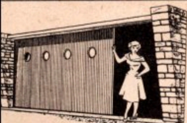
Thùng xe : đây rất nhẹ gấp gọn vào tường, lắp chỗ, không dùng đường rãnh dưới sàn
