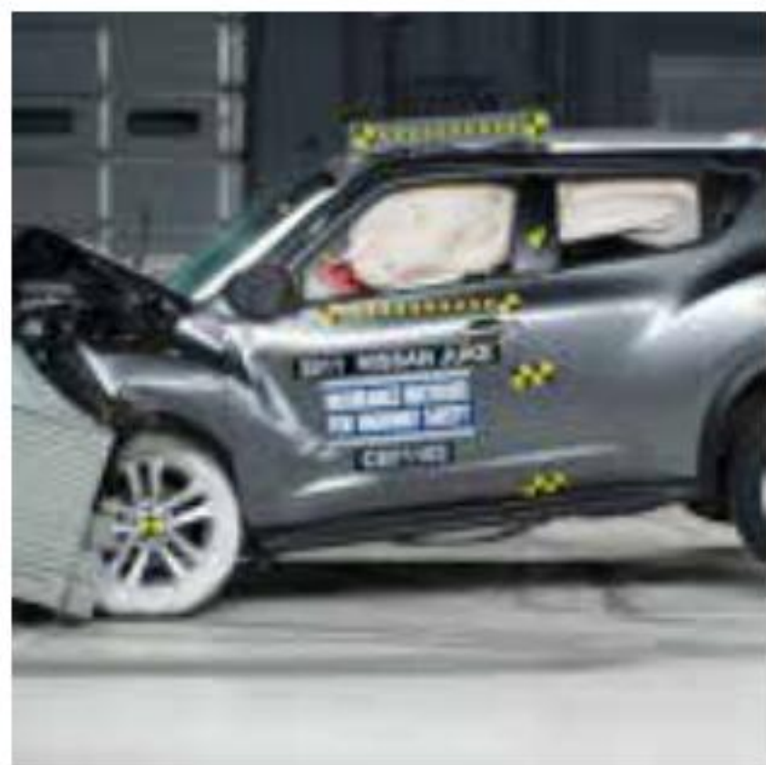
Hình 2: Thử nghiệm xe đụng từ đằng trước, để ý cửa trước ít bị méo mó.
