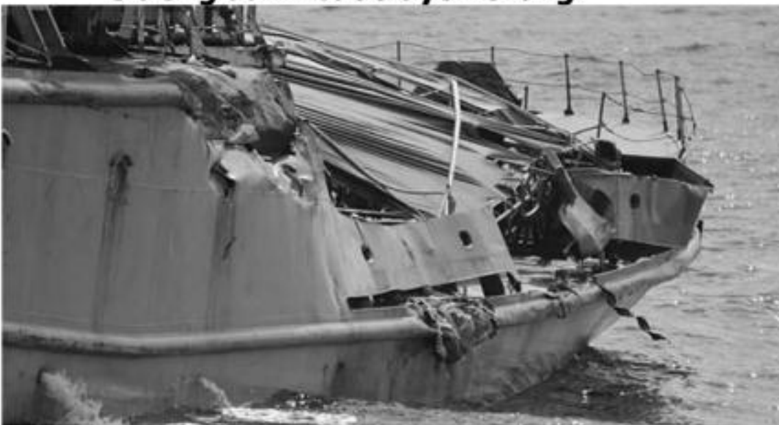
Toàn bộ phần lan can mạn trái sau lái, lan can tầng 1 sau lái tàu kiểm ngư bị biến dạng hoàn toàn. Xuồng chuyển tải bên mạn trái cũng bị đâm thủng - Ảnh: My Lăng
