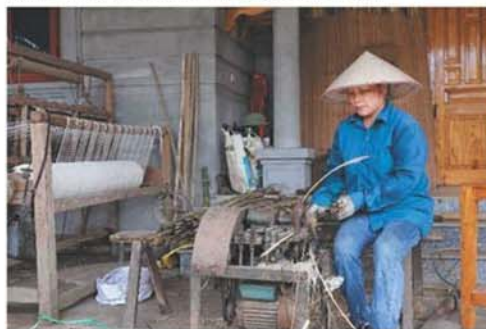
Chị Ma Thị Ngân sử dụng máy vót nan để giảm thiểu công lao động
