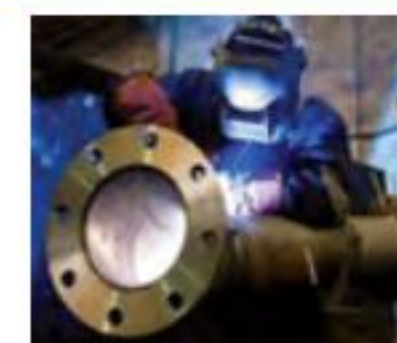
Underlaying 밑깎기 용접 Hàn lót
