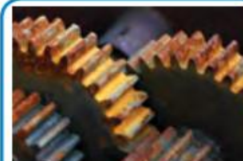
Corrosion 부식 Giỉ, ăn mòn
