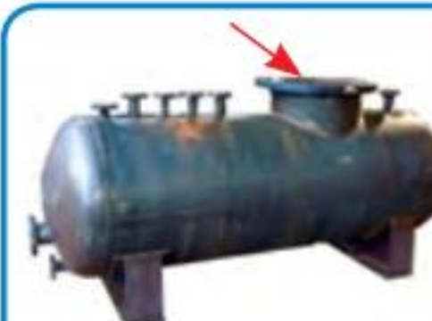
Manhole 맨홀 Lỗ quan sát
