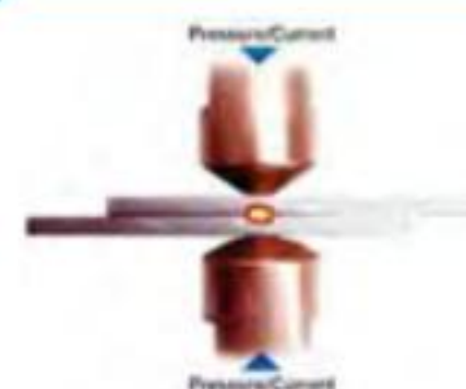
Pressure welding 압접 Hàn áp lực
