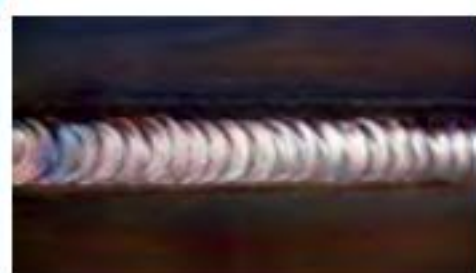
Weld bead 용착비드 Đường hàn
