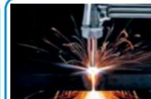
Gas cutting 가스 절단 Cắt bằng khí
