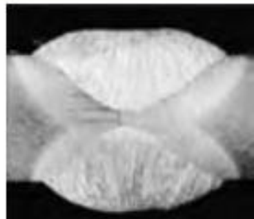
Incomplete penetration 용입 부족 Thiếu thấu
