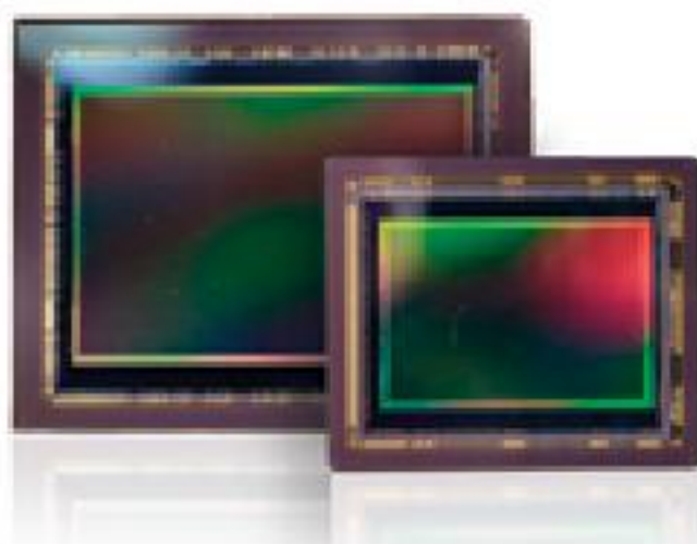
Minh họa trên là cảm biến hình ảnh CMOS Full Frame (trái) và APS-C (phải)
