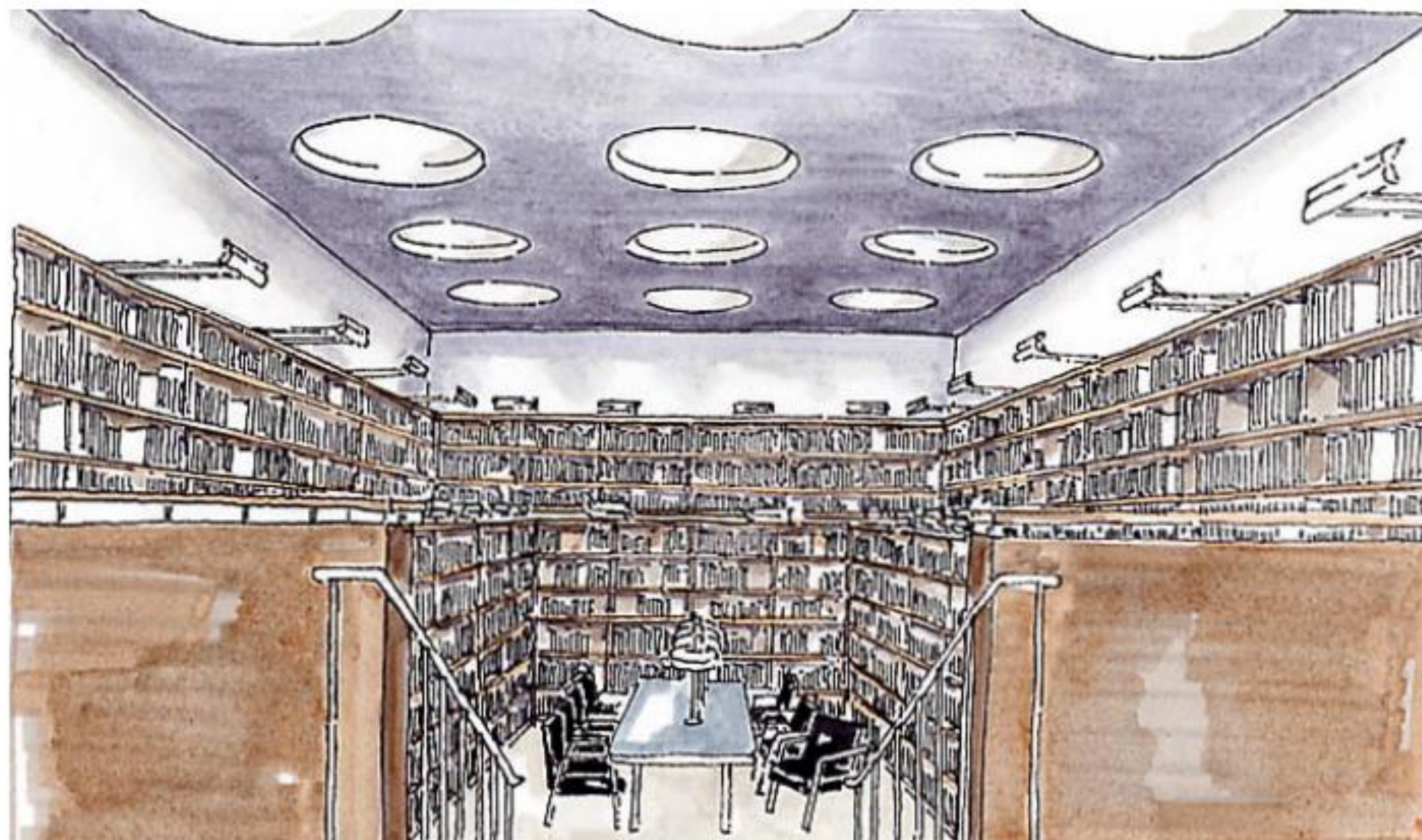
Hệ thống aperture mái mái cho phòng thu đặc biệt của Viện Hưu bổng Quốc gia Helsinki, Phần Lan
