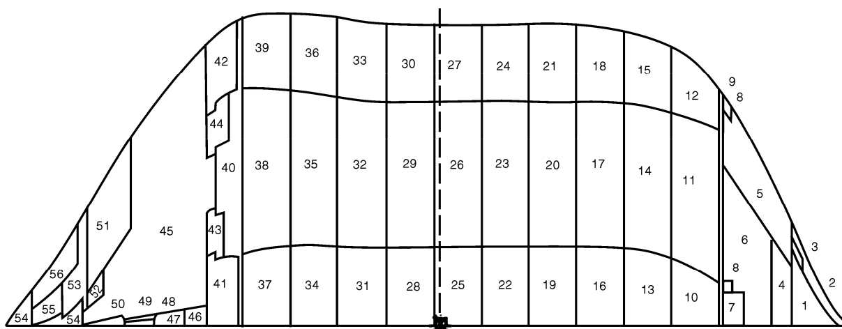
Hình 2.36 Biểu đồ dung tích tàu 30.500dwt
