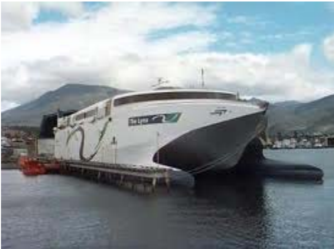
Hình 1.3 Tàu nhóm wave-piercing catamaran
