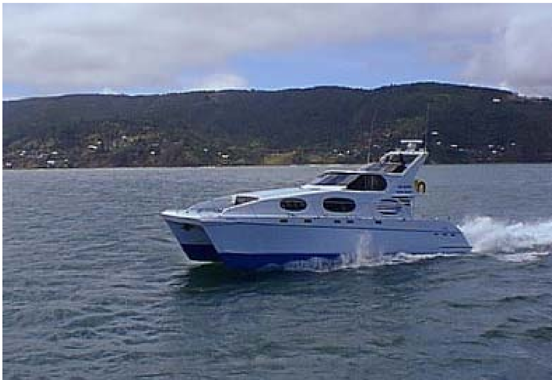
Hình 1.7 Tàu hai thân trên cánh, thiết kế Nam Phi
