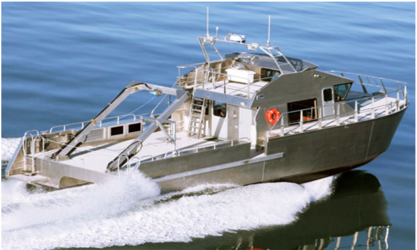
Hình 2.25 Tàu 2 thân kiểu foil-assisted "Kvichak" dài 17 m, vận tốc 30 HU/h
