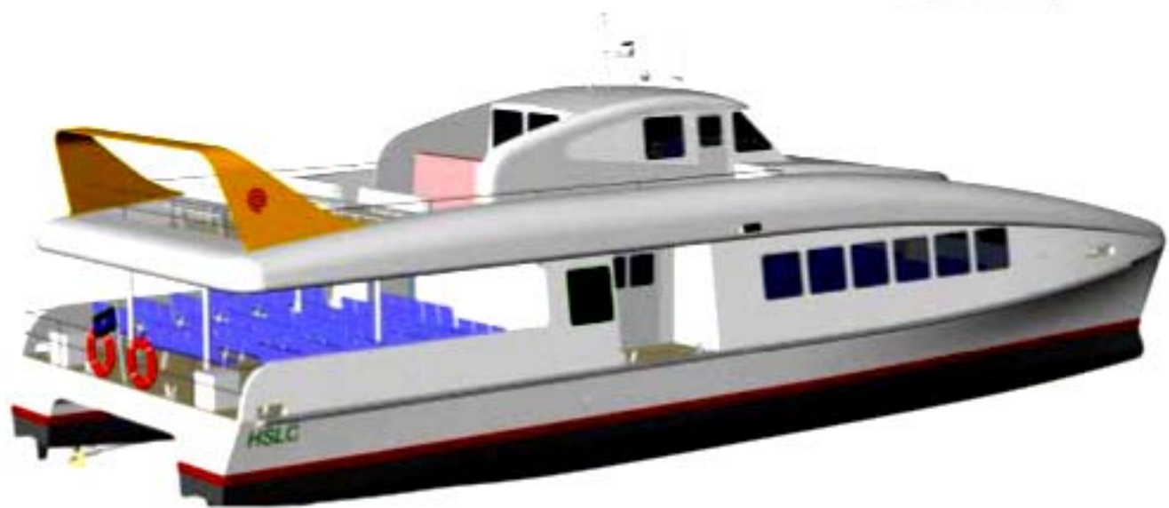
Hình 2.15a Tàu low-wash dài 25 m
