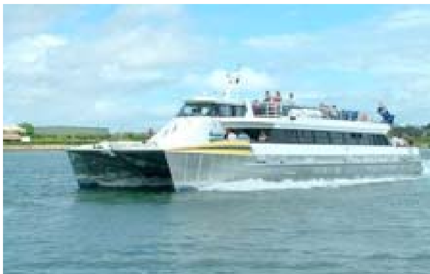
Hình 2.15b Low wash catamaran chạy sông dài 24 m
