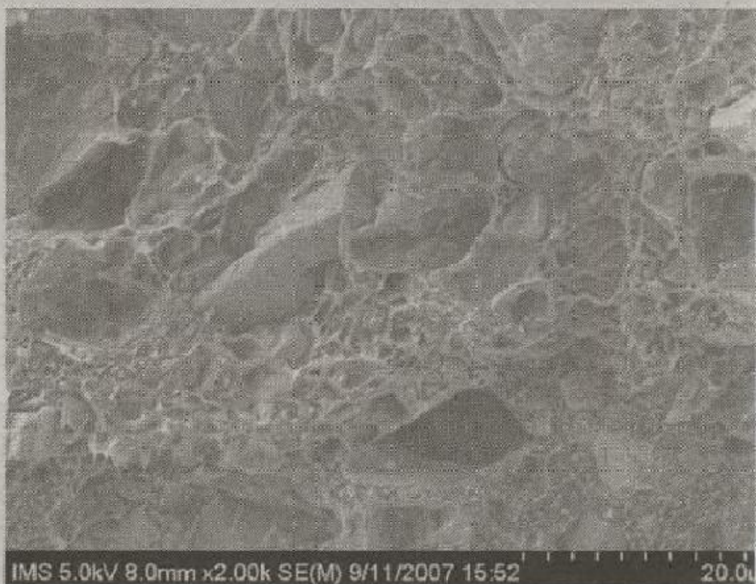
Nhựa tái chế và nhựa không tái chế vẫn có thể chứa chất độn - so sánh ảnh chụp từ kính hiển vi điện tử quét (ảnh do PGS.TS Đỗ Quang Kháng cung cấp)
