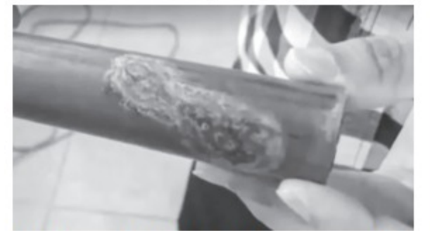
Một người dân Miramar chỉ ra phần ống nước bị hư hỏng ẢNH: CHỤP TỪ CLIP CỦA WPLG
