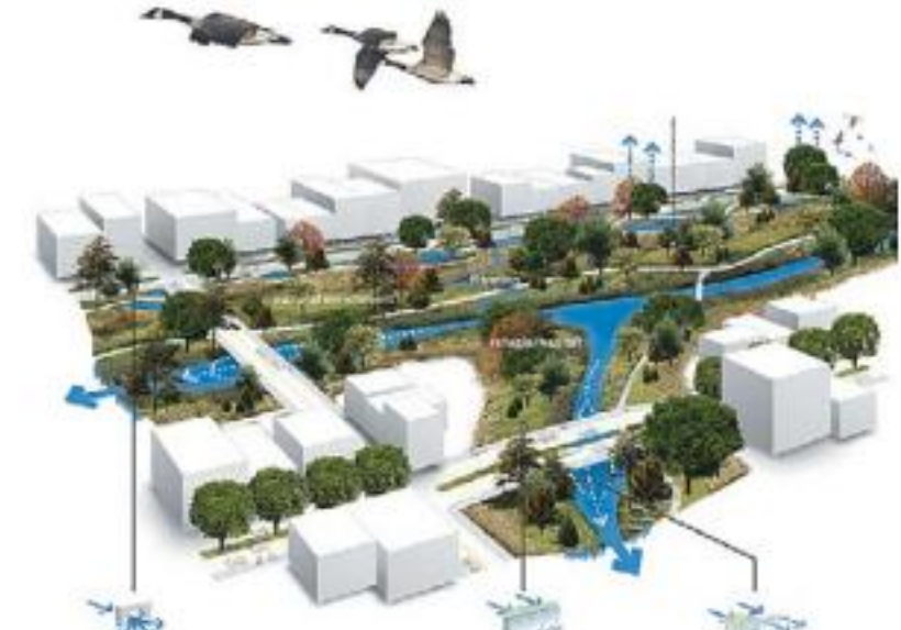
Ảnh 6: Thu gom và xử lý nước mưa dựa trên lớp "Xốp" cảnh quan (Nguồn: Sponge city)
