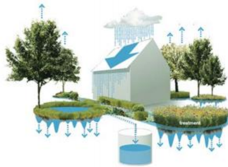
Ảnh 6: Thu gom và xử lý nước mưa dựa trên lớp "Xốp" cảnh quan (Nguồn: Sponge city)
