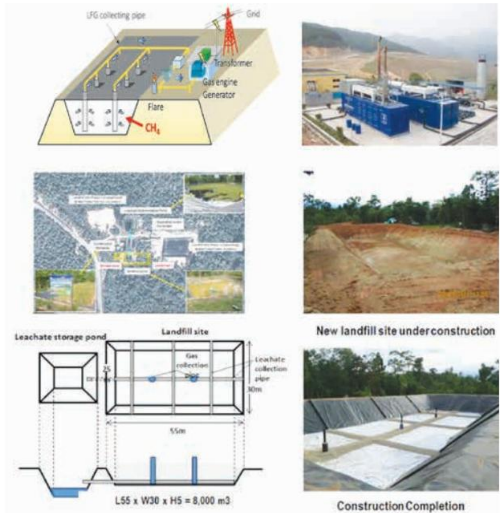
Hình 6. Minh họa về dự án thu gom và biến khí rác thải thành năng lượng khí đốt do công ty EJEC tư vấn thiết kế tại Trung Quốc (trên cùng) và Thái Lan (dưới);
