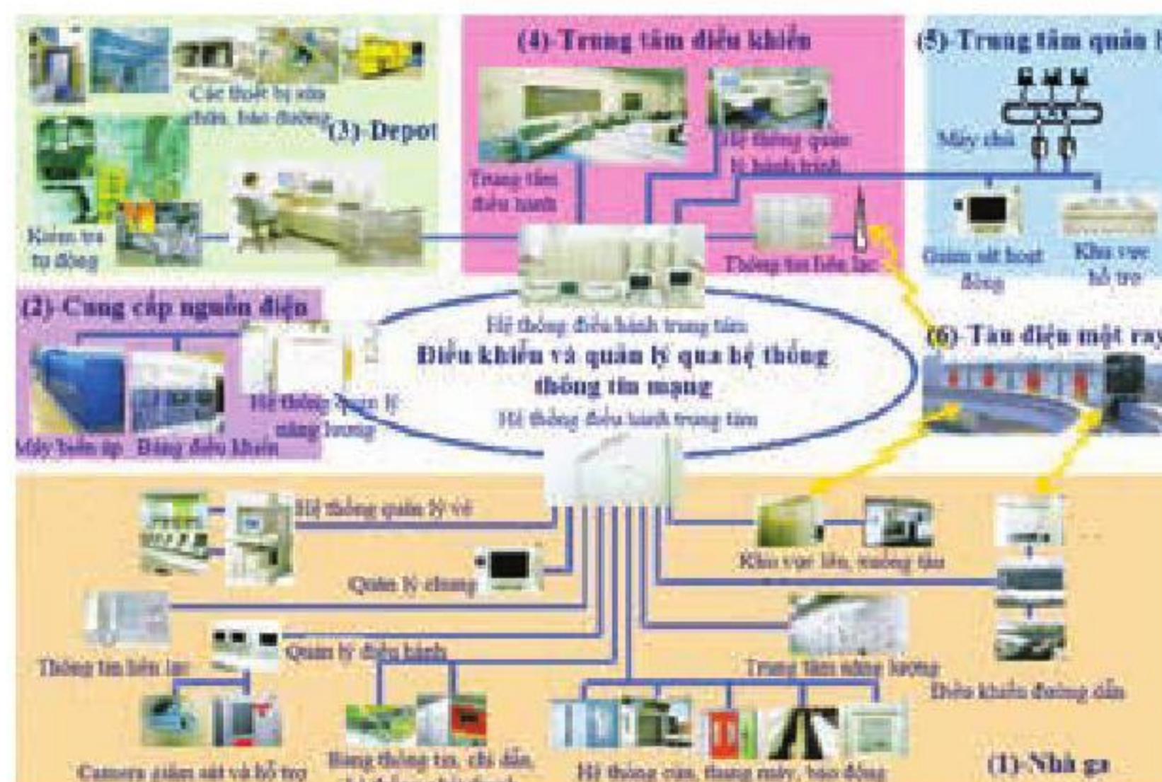
Hình ảnh - 16: Sơ đồ hệ thống quản lý và vận hành tàu điện một ray Nguồn: Hitachi Rail [online] Available at: http://www.hitachi-rail.com/index.html [Accessed 20 July 2014], Japan.
