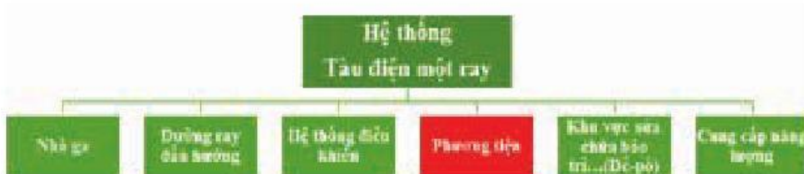
Hình ảnh - 7: Các bộ phận trong hệ thống tàu điện một ray
