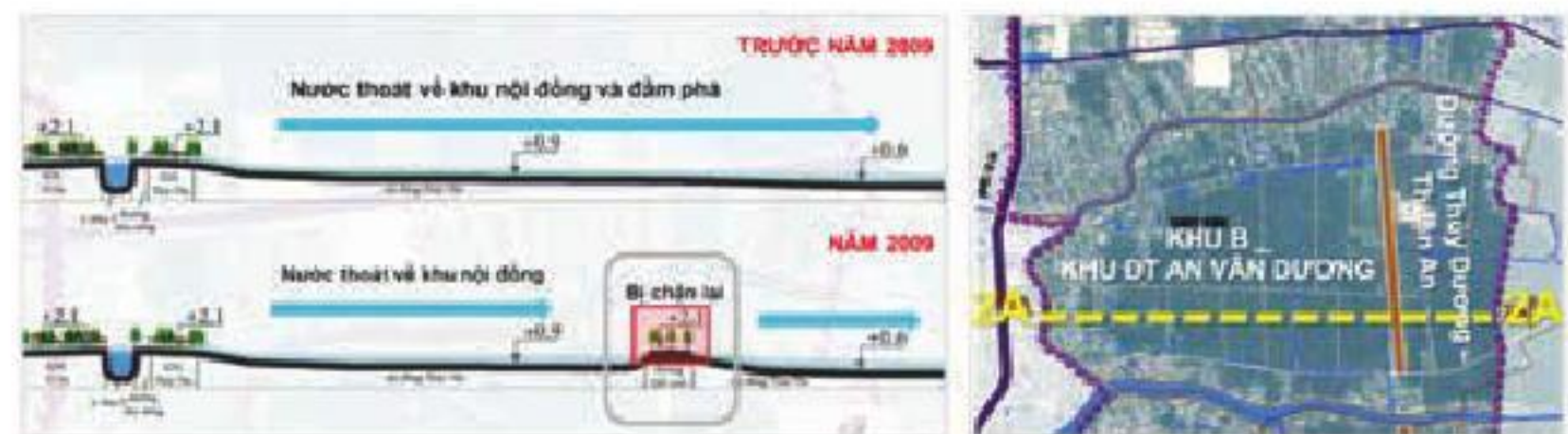
Hình 14: Tác động làm gia tăng úng lụt của đường Thủy Dương - Thuận An ở Khu B
