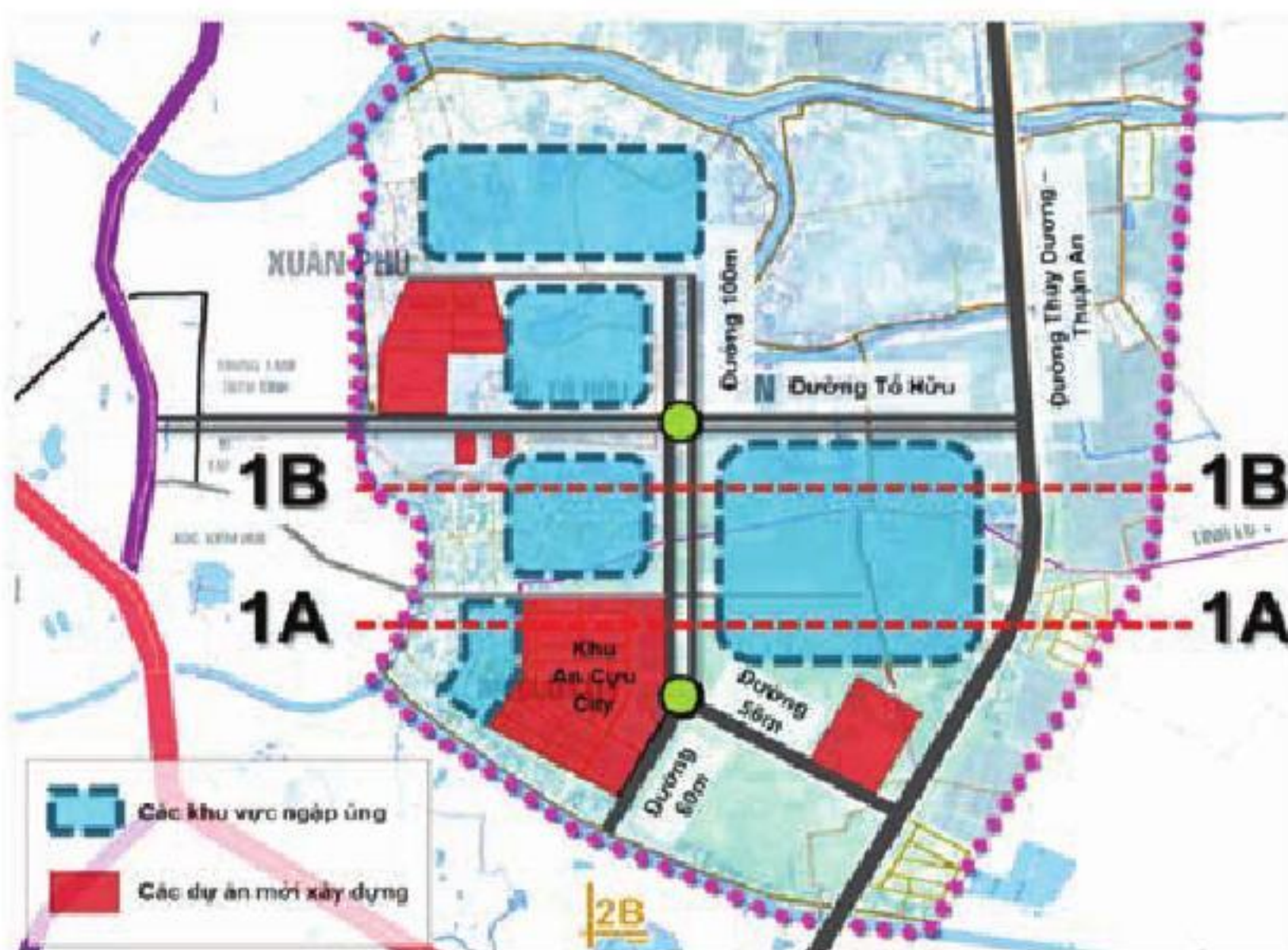
Hình 16: Các ô trũng nhỏ chứa lũ - giữ nước do các trục đường tạo ra
