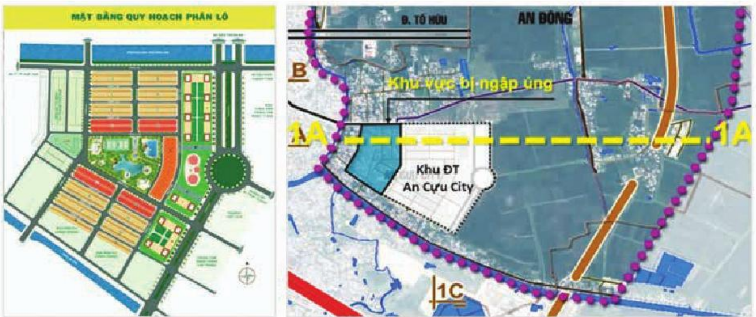
Hình 6: Khu vực bị ngập úng do san lấp và xây dựng khu An Cựu City
