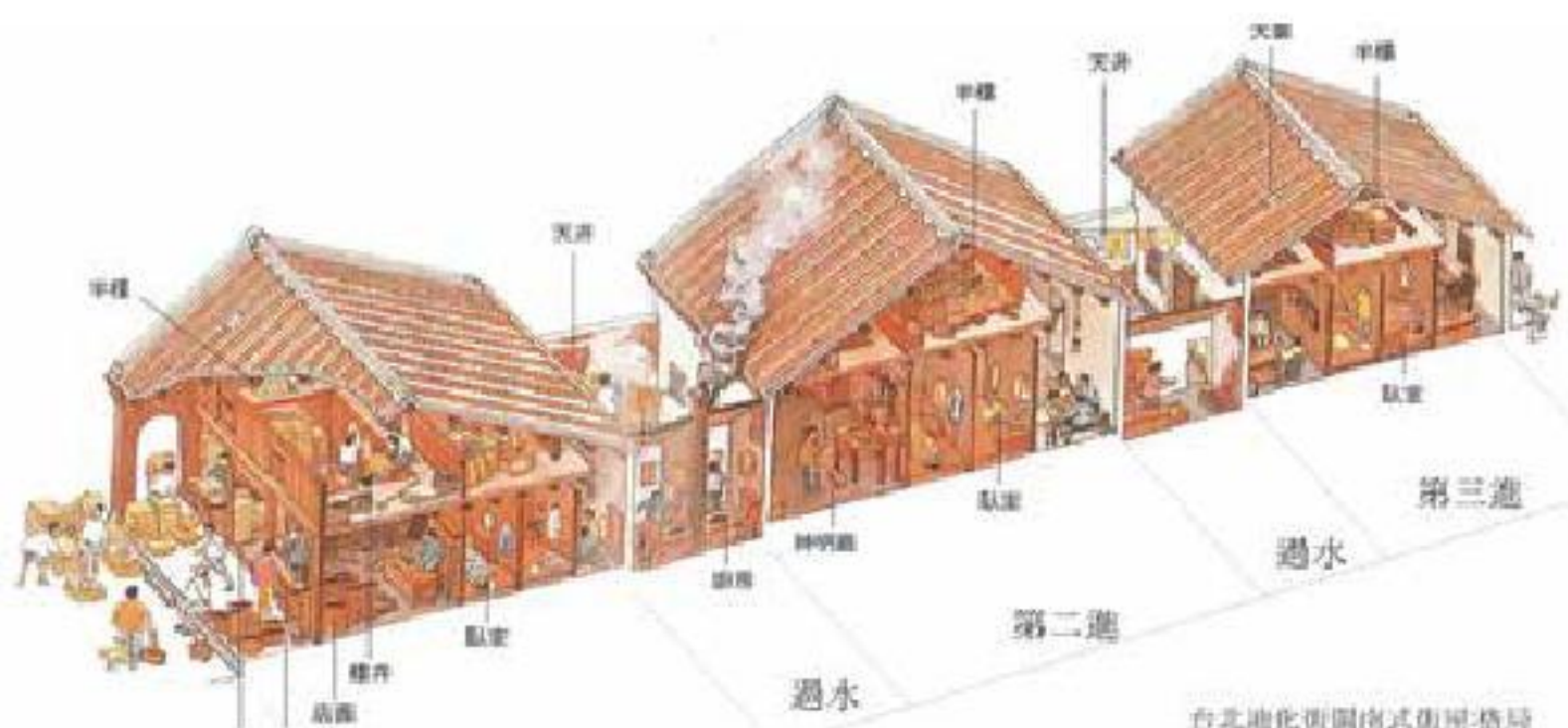
Hình 3. Cấu trúc điển hình nhà hàng phố truyền thống ở Dadaocheng: nhà dạng ống, với 3 lớp nhà, 2 sân trong và 2 hướng tiếp cận trước sau
