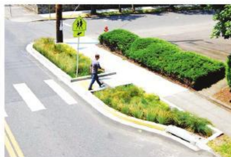
Hệ đường mở rộng thu nước mưa ở các giao lộ được phủ xanh để tăng tính thấm hút nước mưa
