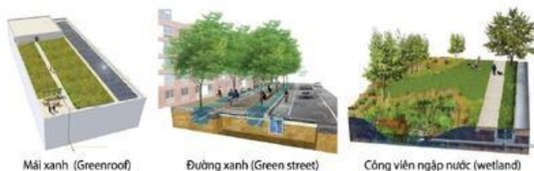
Hình 5: Ba công cụ trong thiết kế đô thị nhằm lưu trữ nước mưa và làm giảm tốc độ và lưu lượng dòng chảy bề mặt. Nguồn: đồ họa của WRT và Sasaki.
