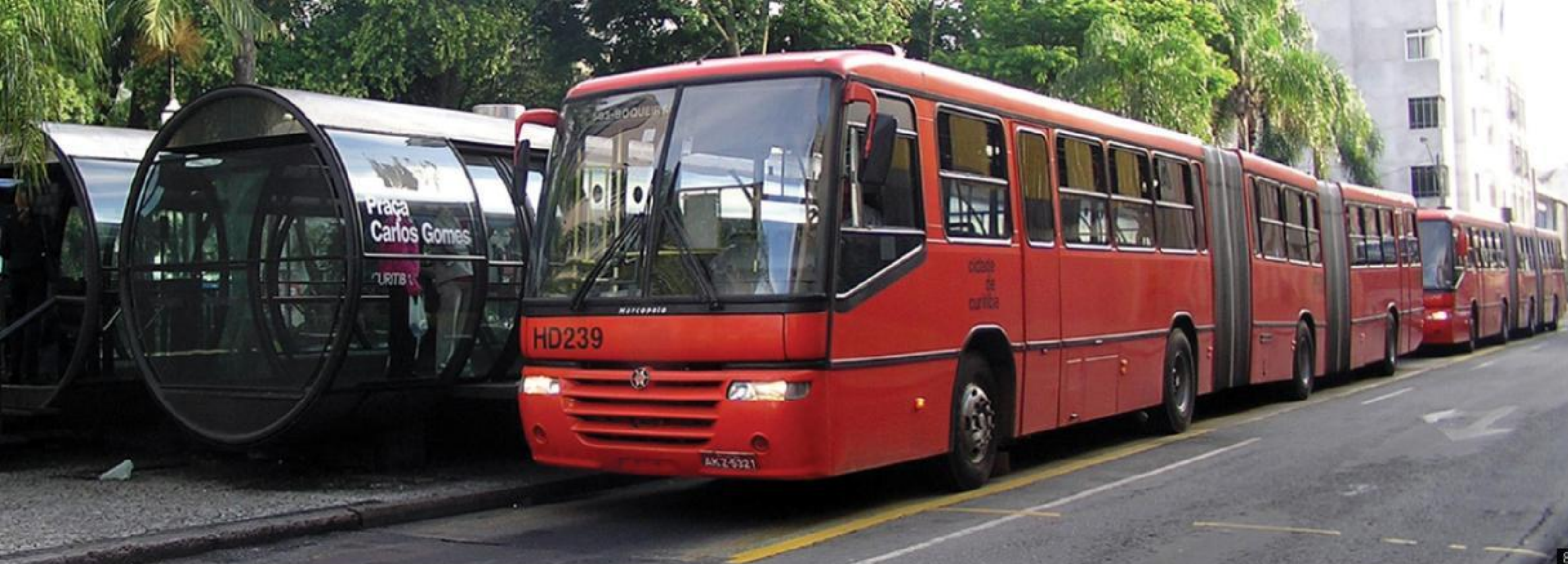
Hình 8: Xe buýt “2 door” được sản xuất tại địa phương. Một xe “2 door” có thể chở 270 hành khách với 5 cửa lớn, nội thất hiện đại và sàn xe thấp để người già, trẻ em và người tàn tật dễ dàng di chuyển lên xuống. Các thành phố khác tại Brazil bắt đầu đặt hàng sản xuất loại xe này từ Curitiba với hy vọng lập lại thành công của thành phố này. Trạm chờ hình ống (boarding tube) cũng là một phát minh “made in Curitiba” nhằm tạo hình ảnh hấp dẫn cho hệ thống BRT. Trạm chờ hình ống với hệ thống soát vé tự động đặt trong trạm chờ giúp giảm thời gian nhận hành khách lên xe buýt. Tuyến “chạy suốt” sử dụng trạm chờ hình ống có khả năng vận chuyển 9.000 hành khách/chiều tuyến/giờ, xấp xỉ năng lực vận chuyển một số hệ thống đường sắt nội đô “bận rộn” nhất thế giới.
