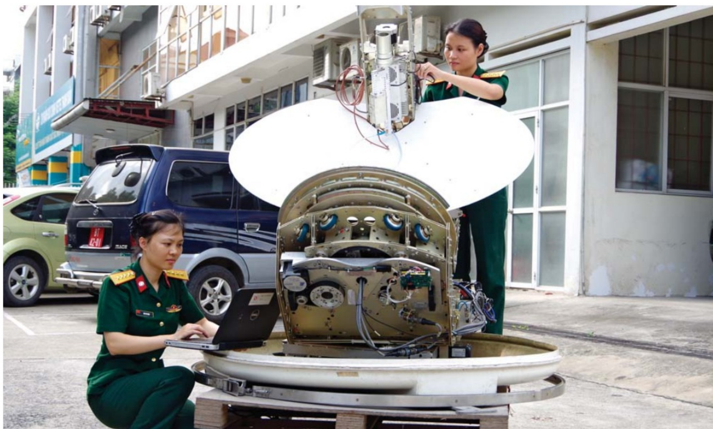
Những nữ kỹ sư Trung tâm KTTT CNC sửa chữa, khắc phục sự cố anten VSAT
