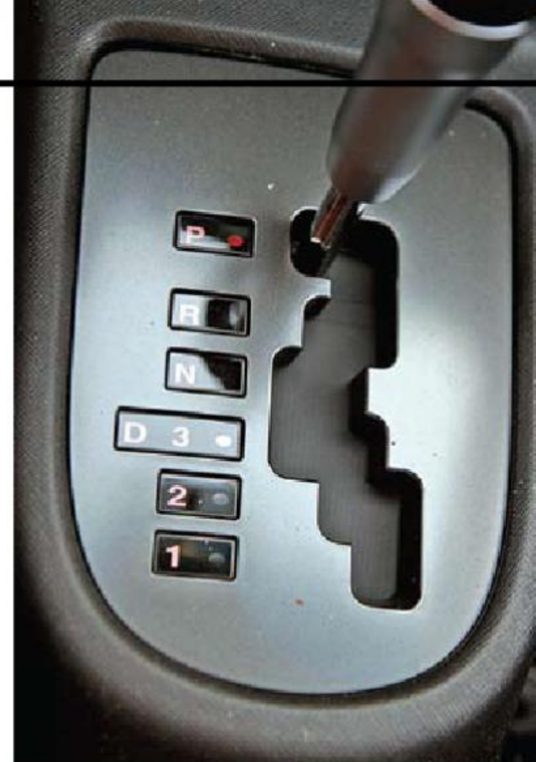
Hộp số kiểu mới, hiện đại và năng động hơn với việc có thêm chế độ đi số 3
