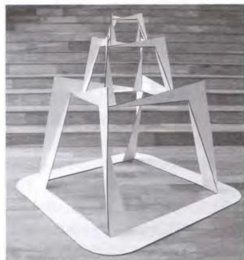
図11 サンドイッチ・パネル試作 120 x 120 x 120cm, t=0.5cm
