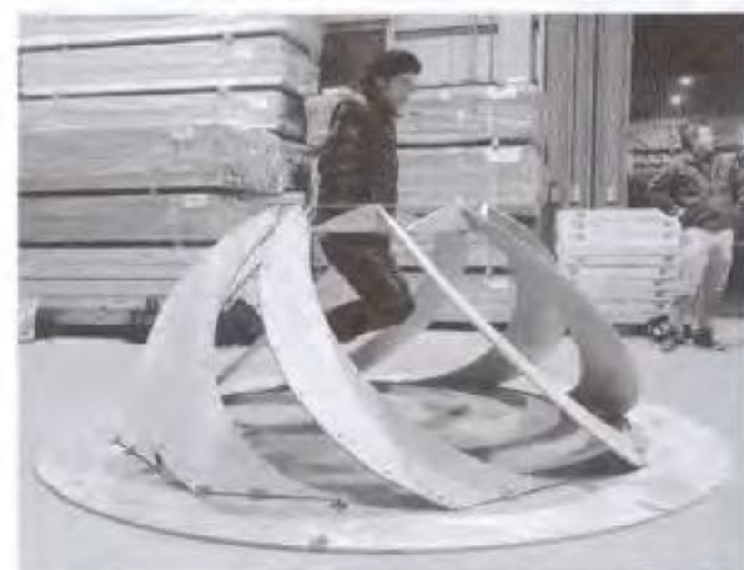
図12 正八角形合板試作 直径212cm、高さ87cm、板厚1.2cm
