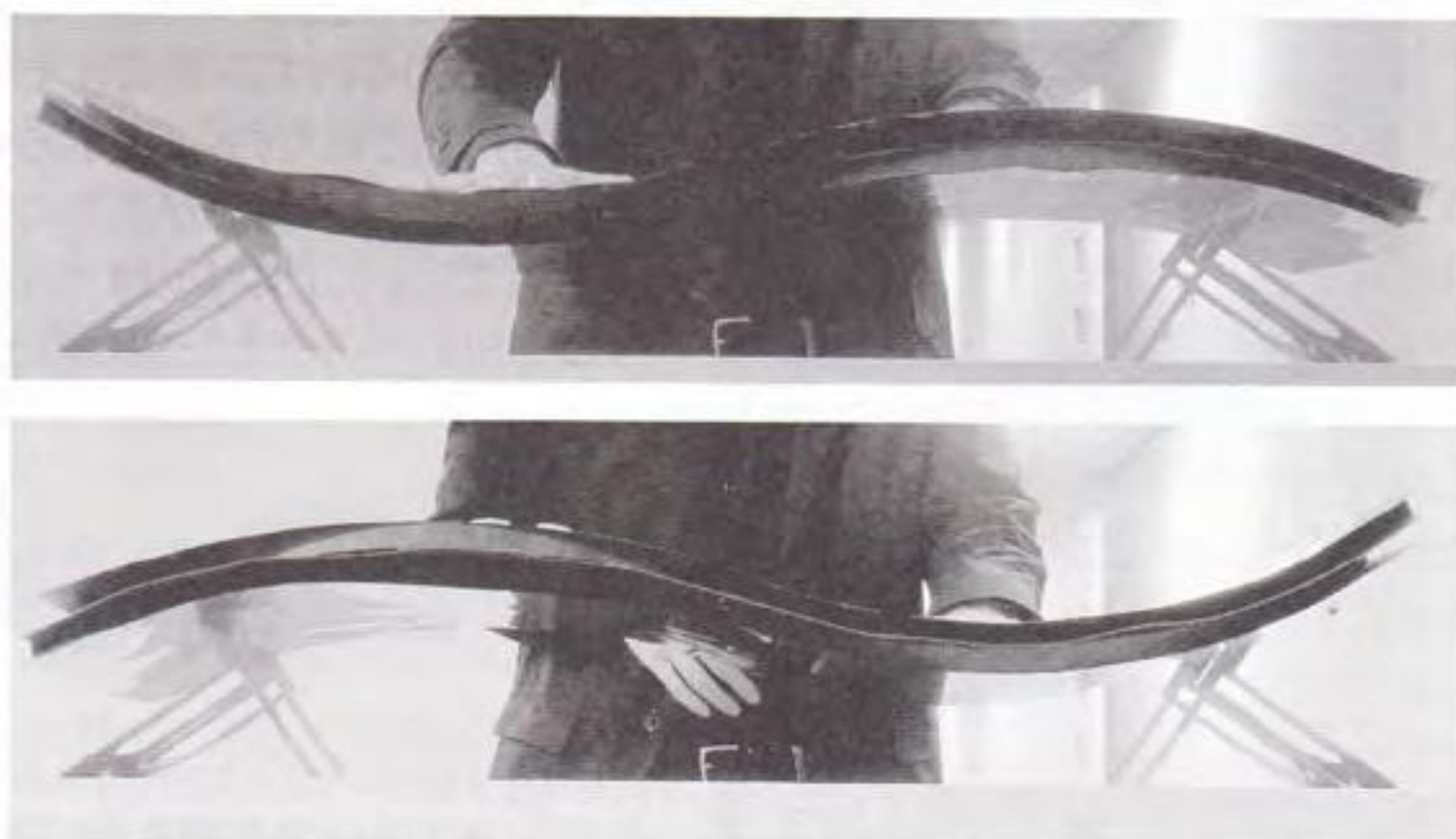
図10:S字形にのみ変形可能なサンドイッチパネル。中心を押しても変形をしない
