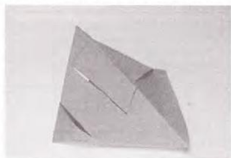
図5 実際に折鶴型の展開図から製作した準正四面体
