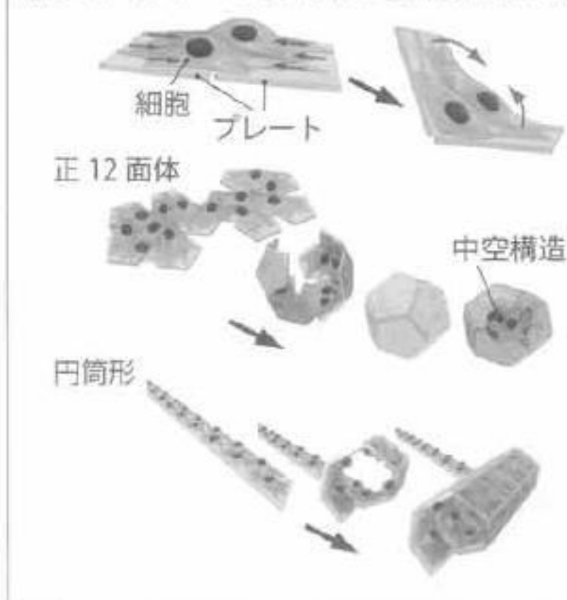
図2 細胞折り紙で立体構造を作るしくみ
