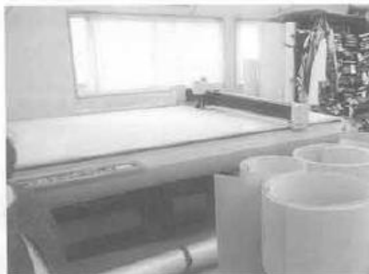
▲昔は、カルトンの作図は職人が手描きで行っていましたが、南海プリーツでは現在、パターンをCAD(コンピュータによる製図)で作成し、業務用の大型カッティングプロッタを使って紙に折り目を転写(ハーフカット)しています。最大で120×180cmのサイズの紙に転写できるそうで、折り紙者にとっても欲しくなってしまう機械ですが、システム込みで500万円以上するようです……
