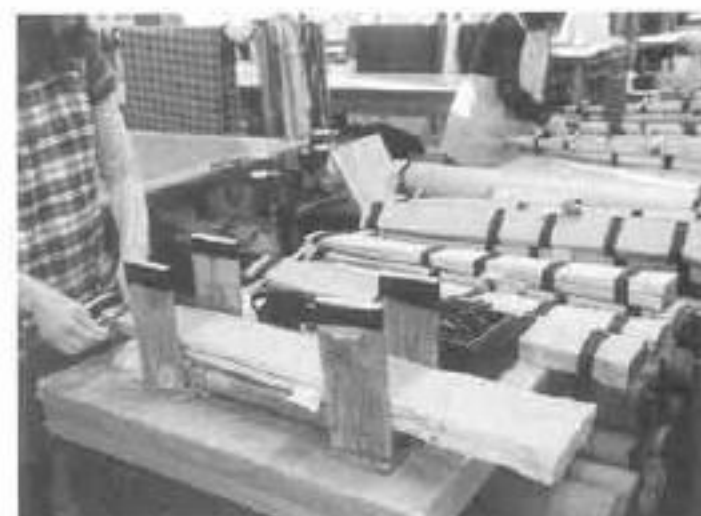
▲アコーディオンプリーツの型紙で布を挟んだ後、固定しているところ。これが窯に入ります
