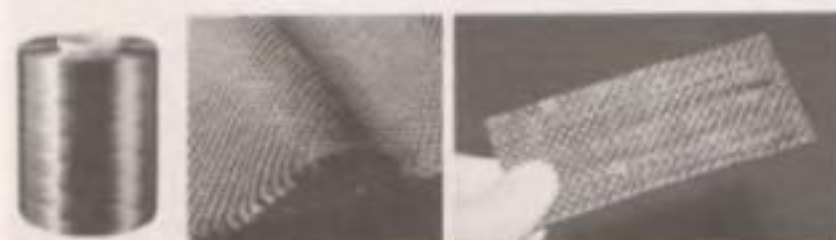
図1 左からカーボン繊維、平織クロス材、CFRP板
