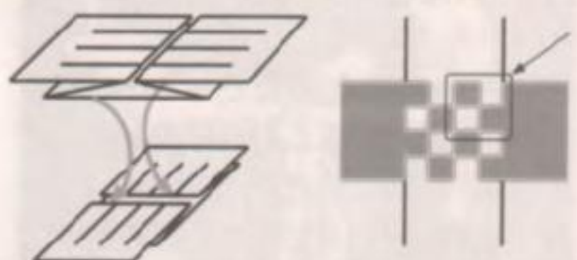
図12 片面市松十字の組み立ての様子
