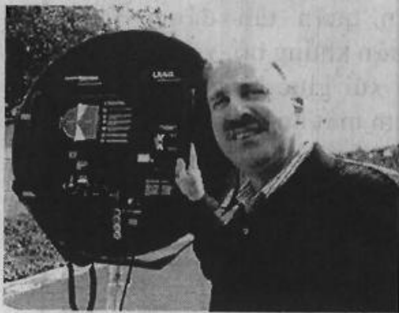
LRAD-Long Range Acoustic Device, "máy la" của Mỹ
