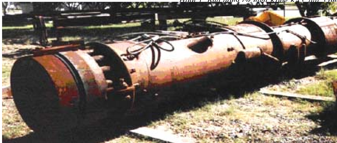
Hình 1. Búa đóng cừ hiệu Kobe K45, dài 5,6m,
