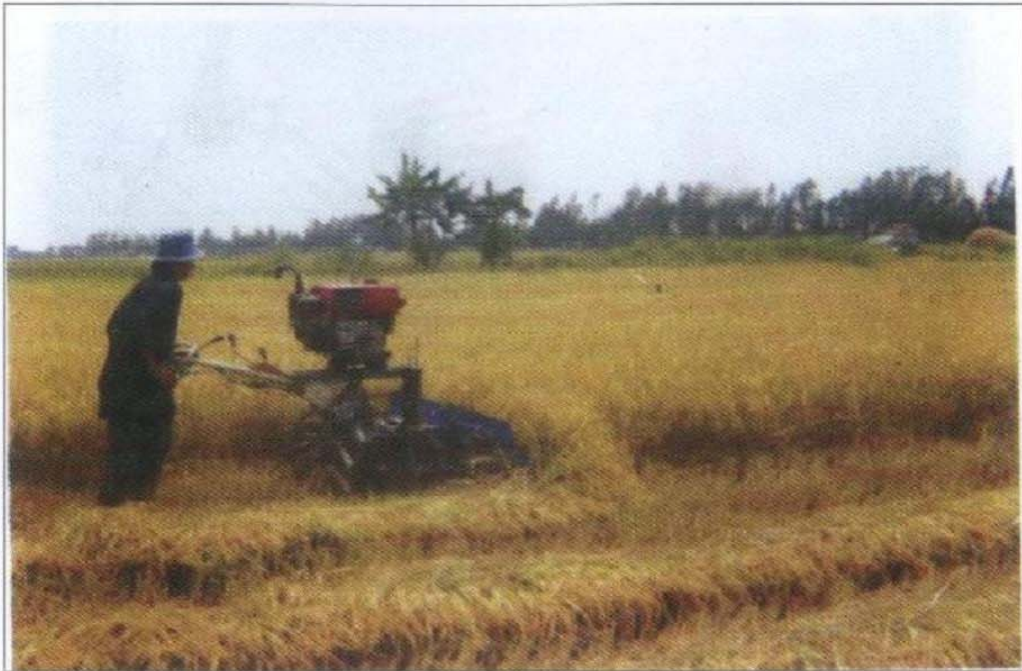
Hình 11. Máy gặt rải hàng GRH-1,2 làm việc trên đồng (Công ty cơ khí Thái Bình chế tạo)
