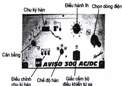
Hình 1.8. Sơ đồ bố trí các nút điều khiển của máy hàn SAF
