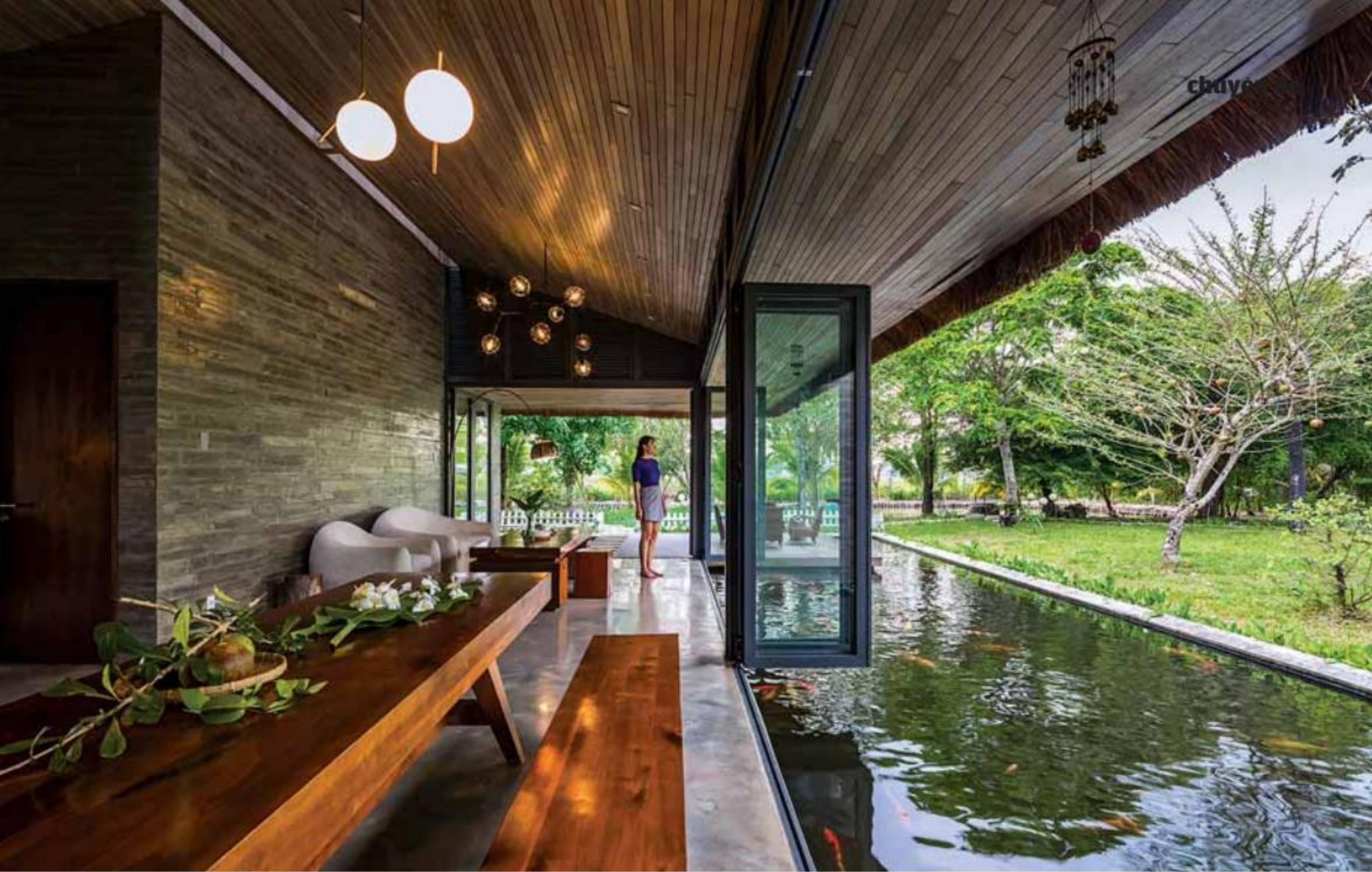
Giải pháp thông gió tự nhiên nhờ bố cục tách khối, hệ cửa mở, hồ nước làm mát không khí. Ảnh: Am house - CTA
