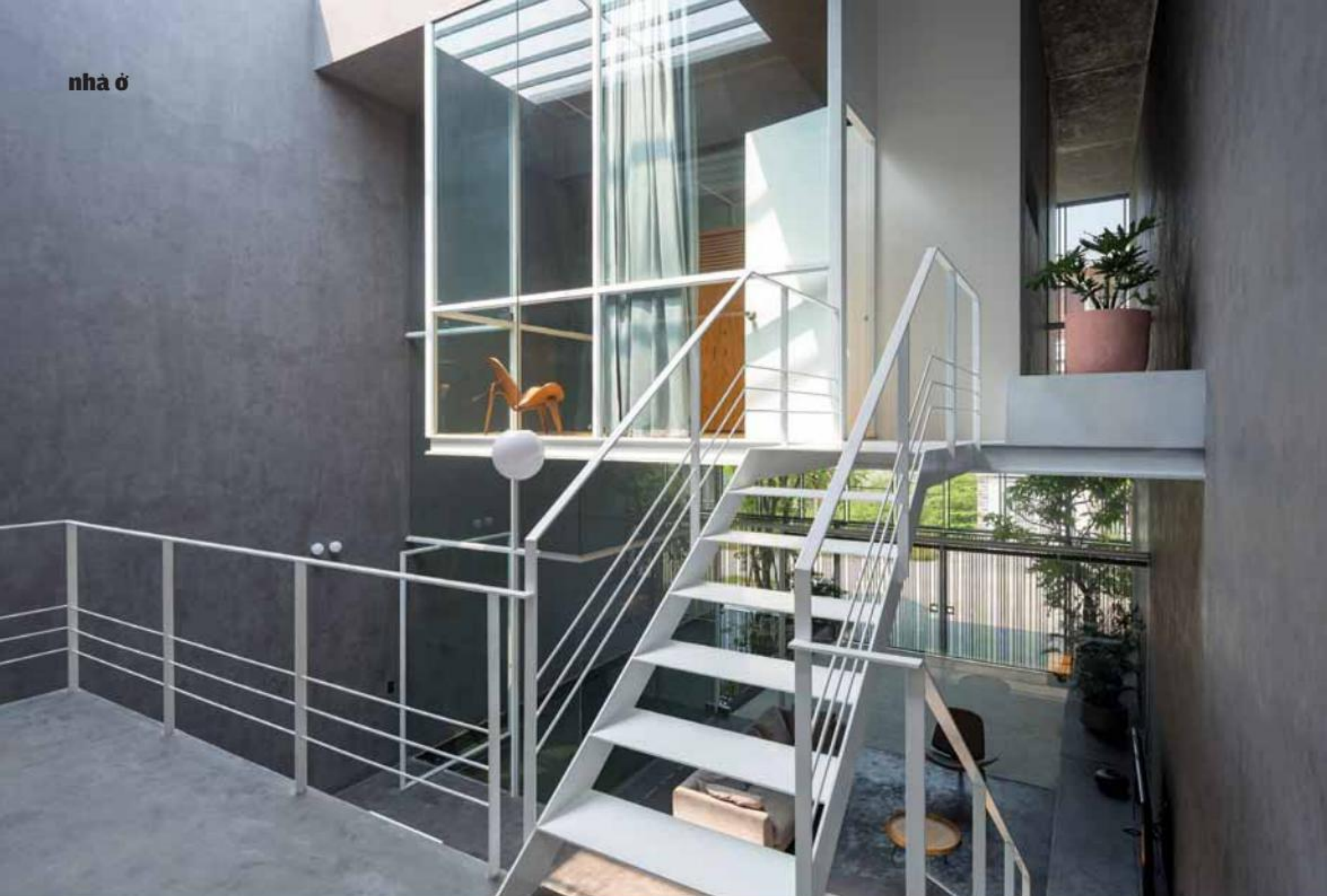
Các phòng ngủ được làm từ vật liệu nhẹ, phù hợp kết cấu treo. Ánh sáng được dẫn dắt từ 3 khoảng giếng trời đến những không gian sinh hoạt chung trong nhà
