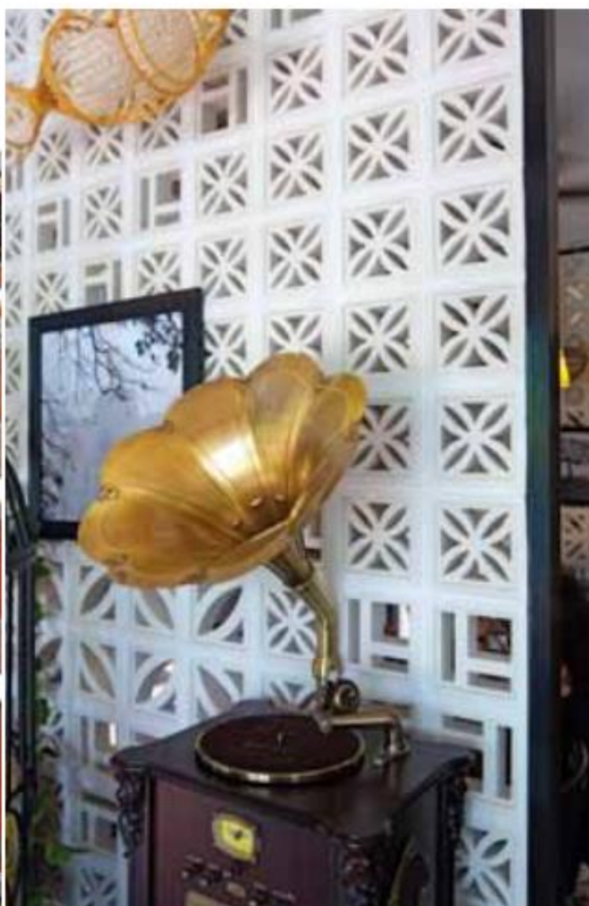
Hệ gạch bông gió có nhiều khả năng khai thác về tạo hình và che chắn cho nội ngoại thất nhà phố
