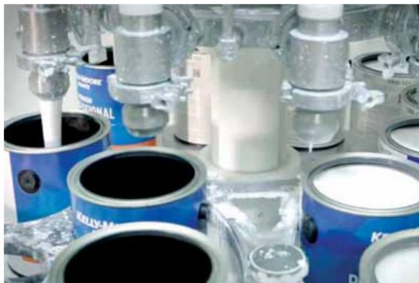
Sơn thành phẩm được chiết rót tự động
