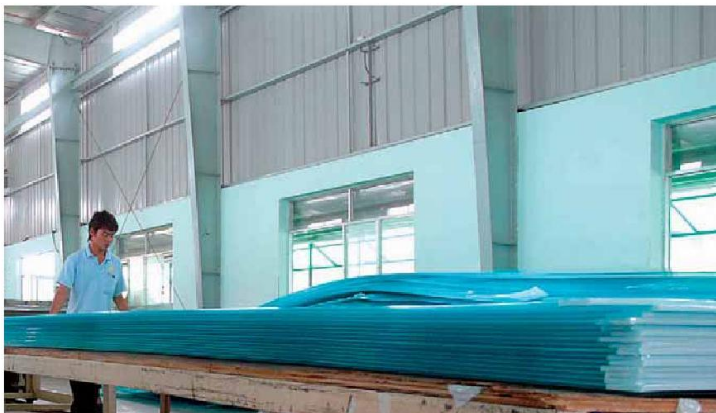
Ảnh trang bên Các vật liệu làm mái đa dạng và phong phú. Ảnh dưới Một loại tấm lợp nhựa có thể vừa bảo vệ nhà vừa lấy sáng.
