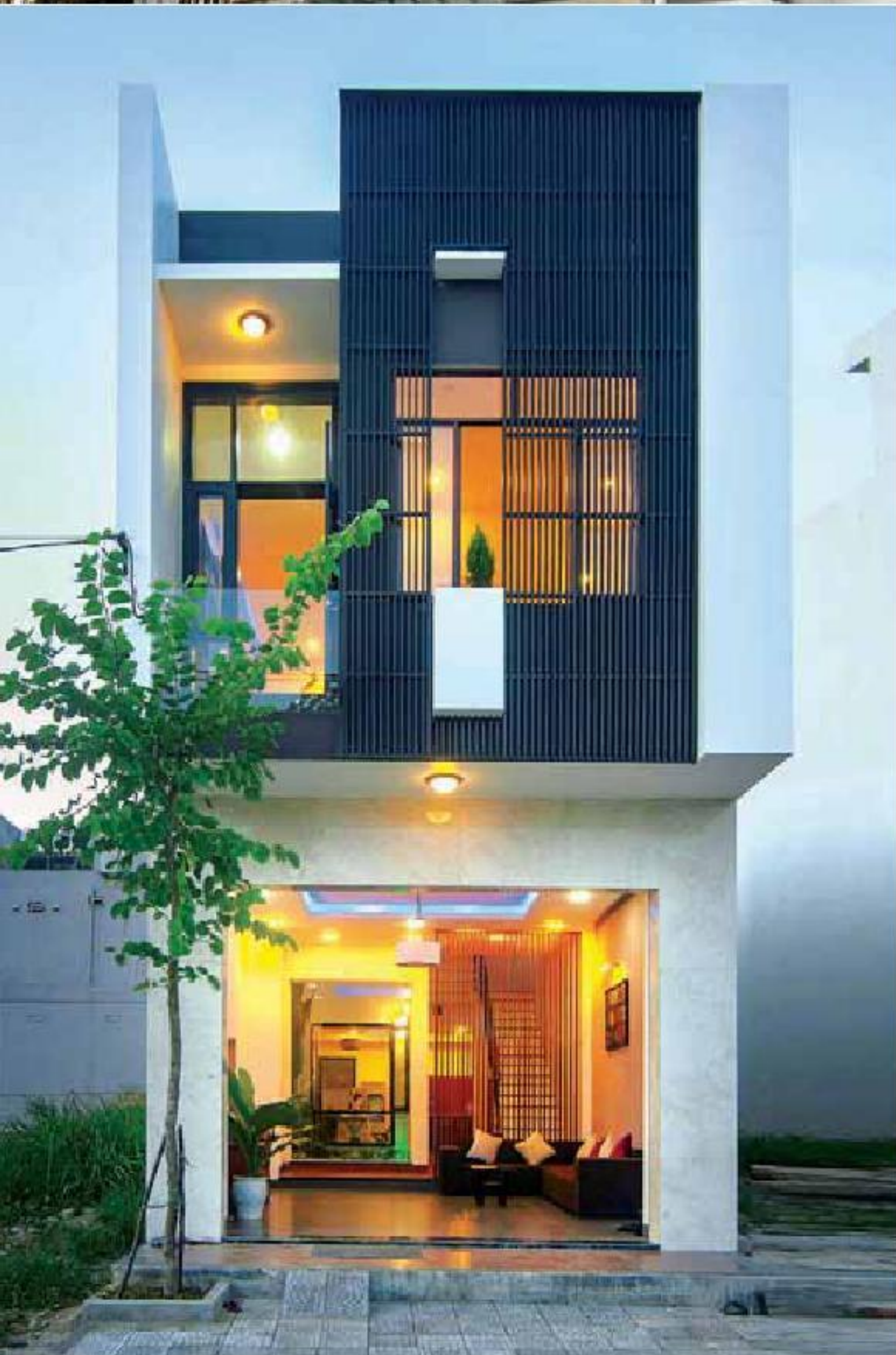
Ảnh trên Khai thác khả năng tạo hình và che chắn của lam nhôm hiện đại được nhiều nơi từ Singapore đến châu Âu ưa chuộng. Ảnh dưới Che nắng hướng tây với lam đứng kết hợp mái ngang và mảng đặc lớn khá phù hợp.
