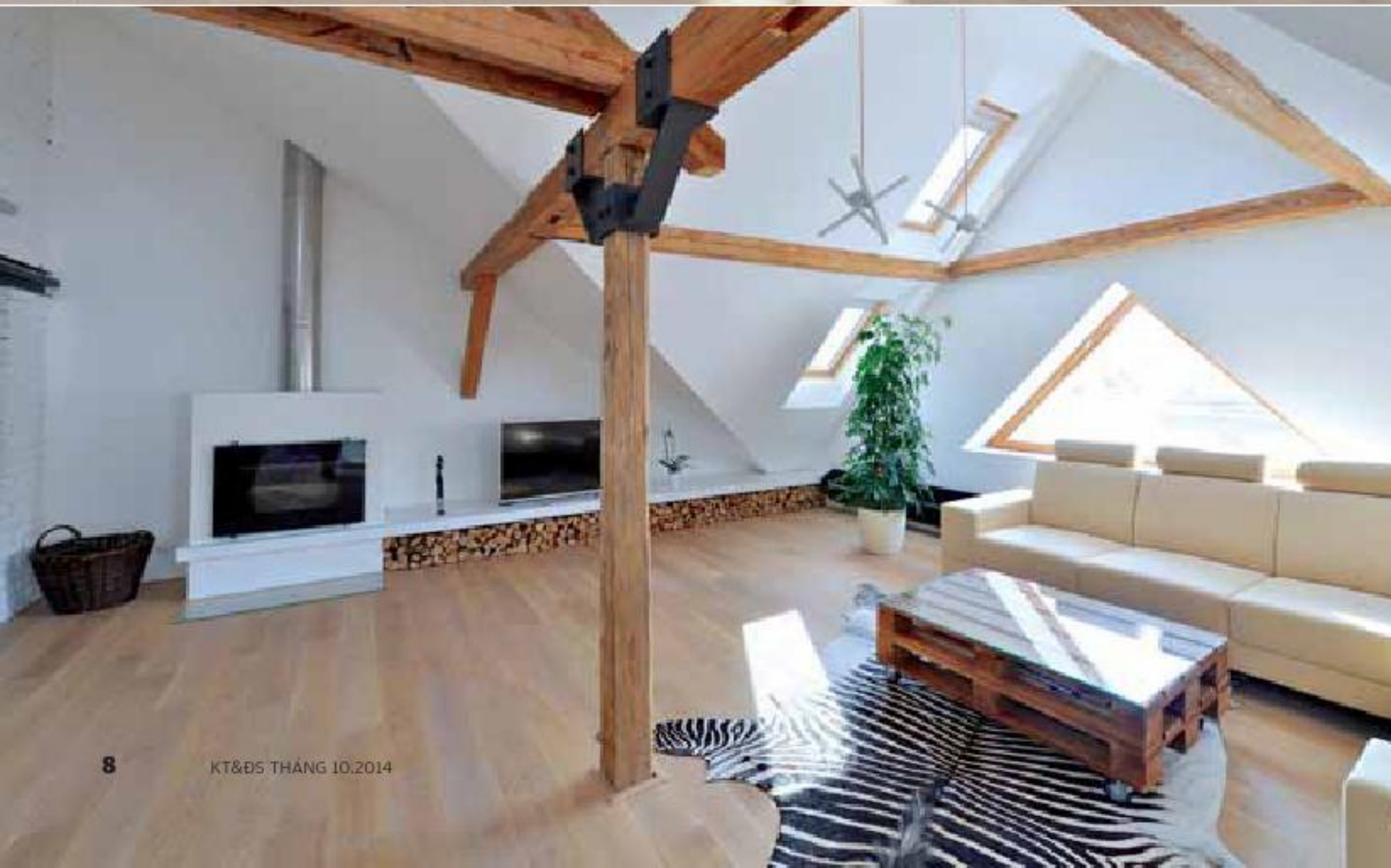
Ảnh trên và dưới Ánh sáng của căn áp mái được lấy từ những ô cửa vát trở từ mái nhà. Các dầm gỗ chịu lực được gia cố bản lề thép tạo nên vẻ đẹp mạnh và chắc chắn.
