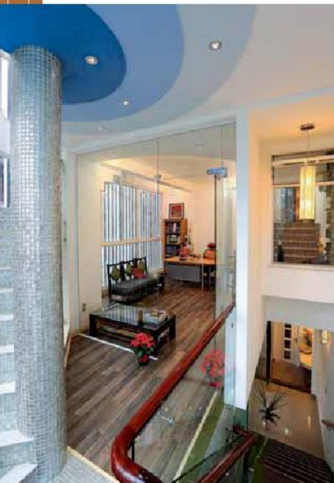
Việc liên thông không gian qua giếng trời, thông tầng... luôn giúp gió luân chuyển trong nhà, đưa ánh sáng vào sâu, giảm bớt bức bối tối tăm cho nội thất.
