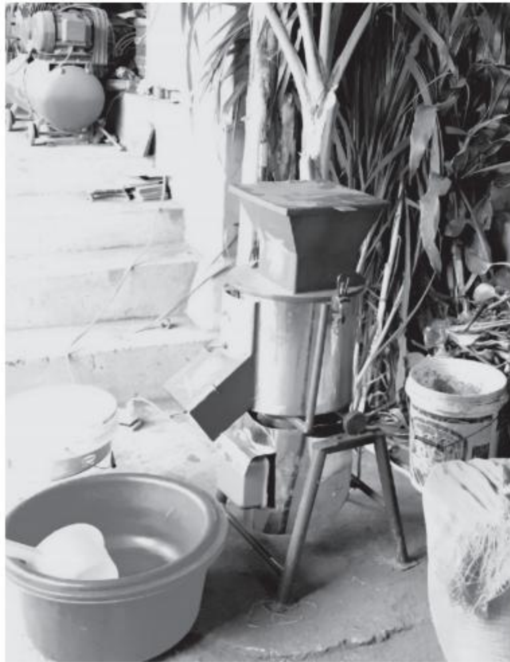
Một chiếc máy chế biến thức ăn chăn nuôi cỡ nhỏ do ông Giang chế tạo, bên cạnh là các nguyên liệu để đưa vào máy (cây chuối, bèo...). Ảnh: NVCC
