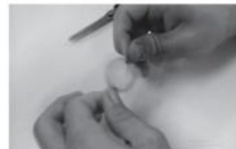
3 Cắt bớt ngắn hai đầu của cuộn dây đồng để xoay.
