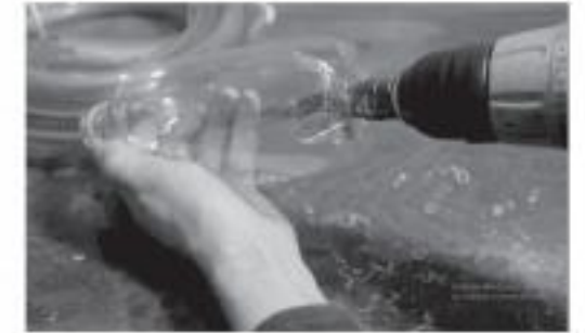
4 Khoan 1 lỗ tại chai nước.
