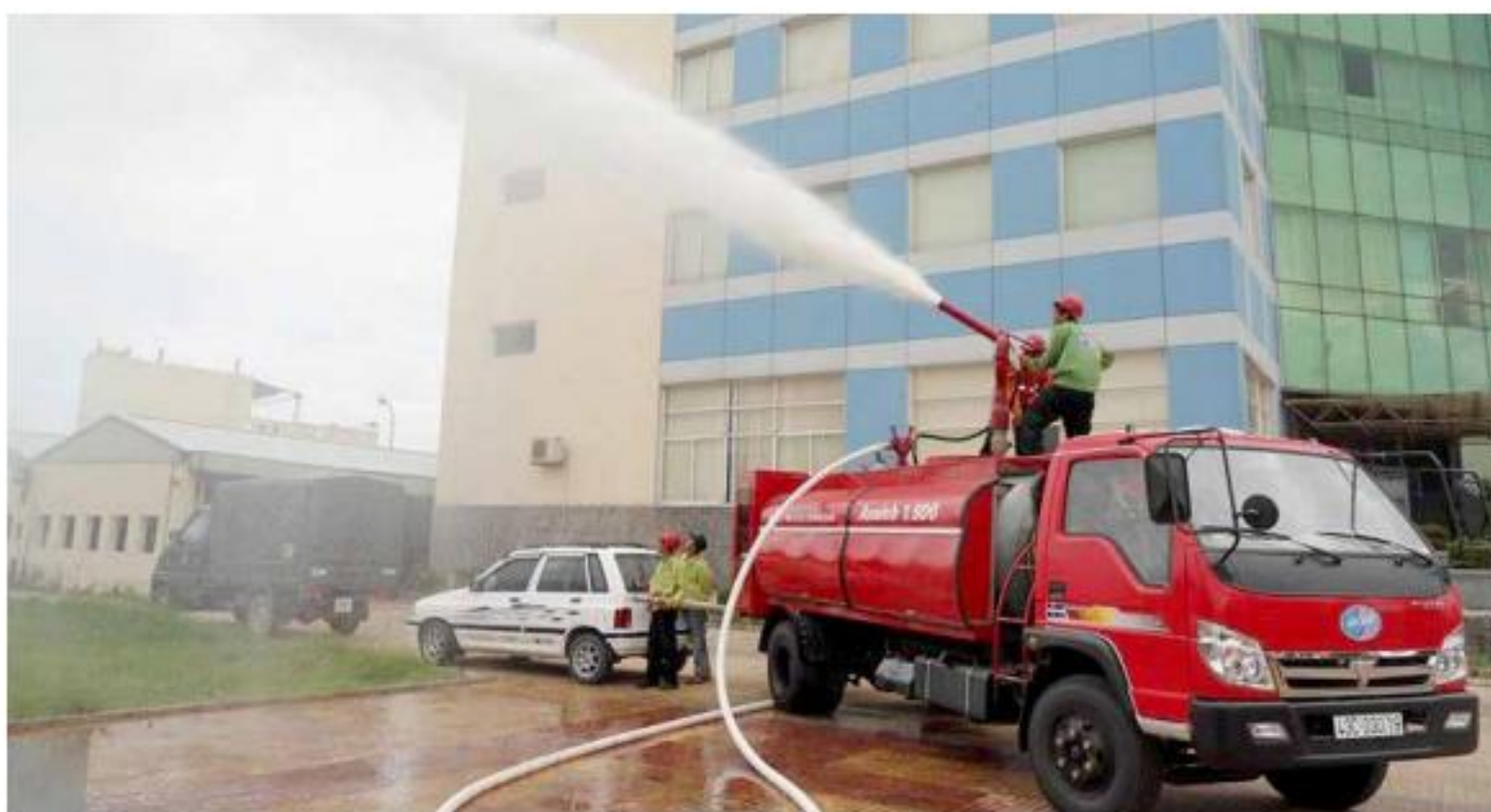
Súng D50 trong hệ thống thiết bị chữa cháy AFFA 1500 có thể phun hơi nước thẳng, rộng 3-4m, xa 40-50m.
