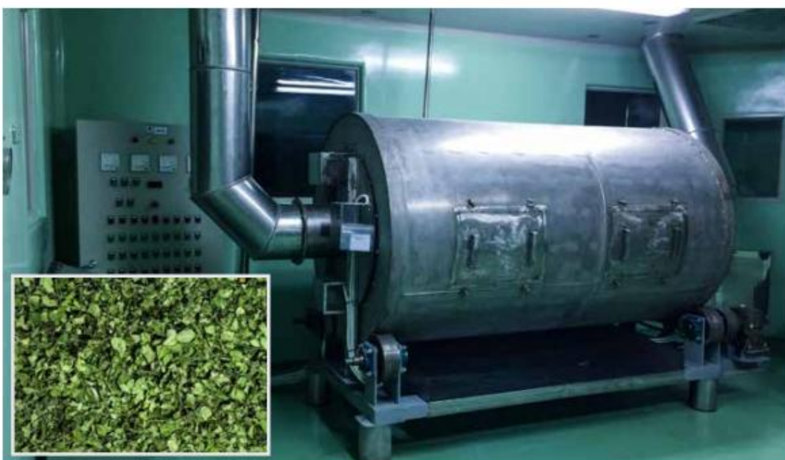
Với hệ thống sấy bơm nhiệt kết hợp vi sóng, màu sắc của sản phẩm vẫn giữ được 80%.
