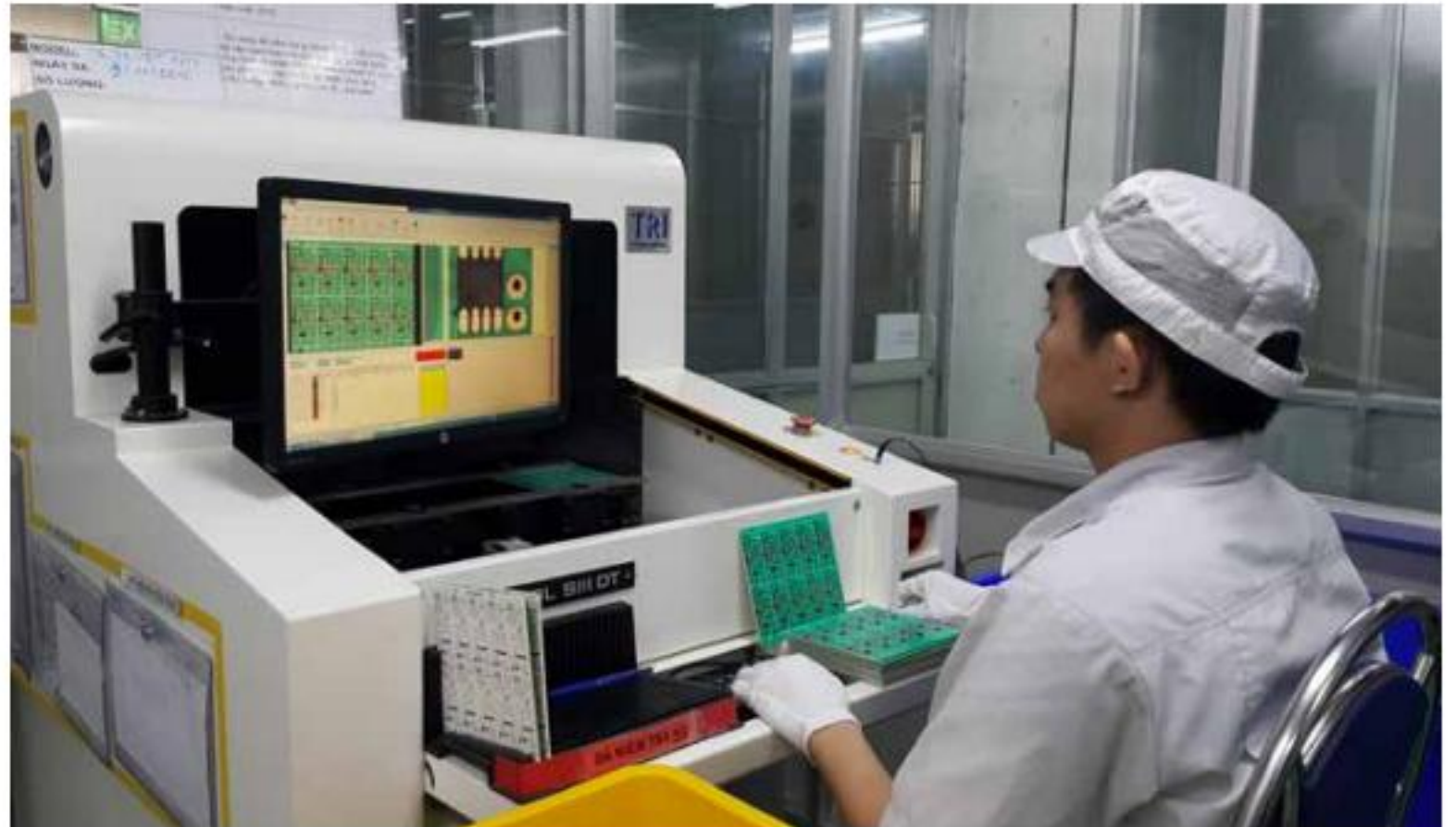
Máy siêu âm tự động kiểm tra lọc các linh kiện bị lỗi được Công ty bóng đèn phích nước Rạng Đông chuyển giao công nghệ từ Mỹ.
