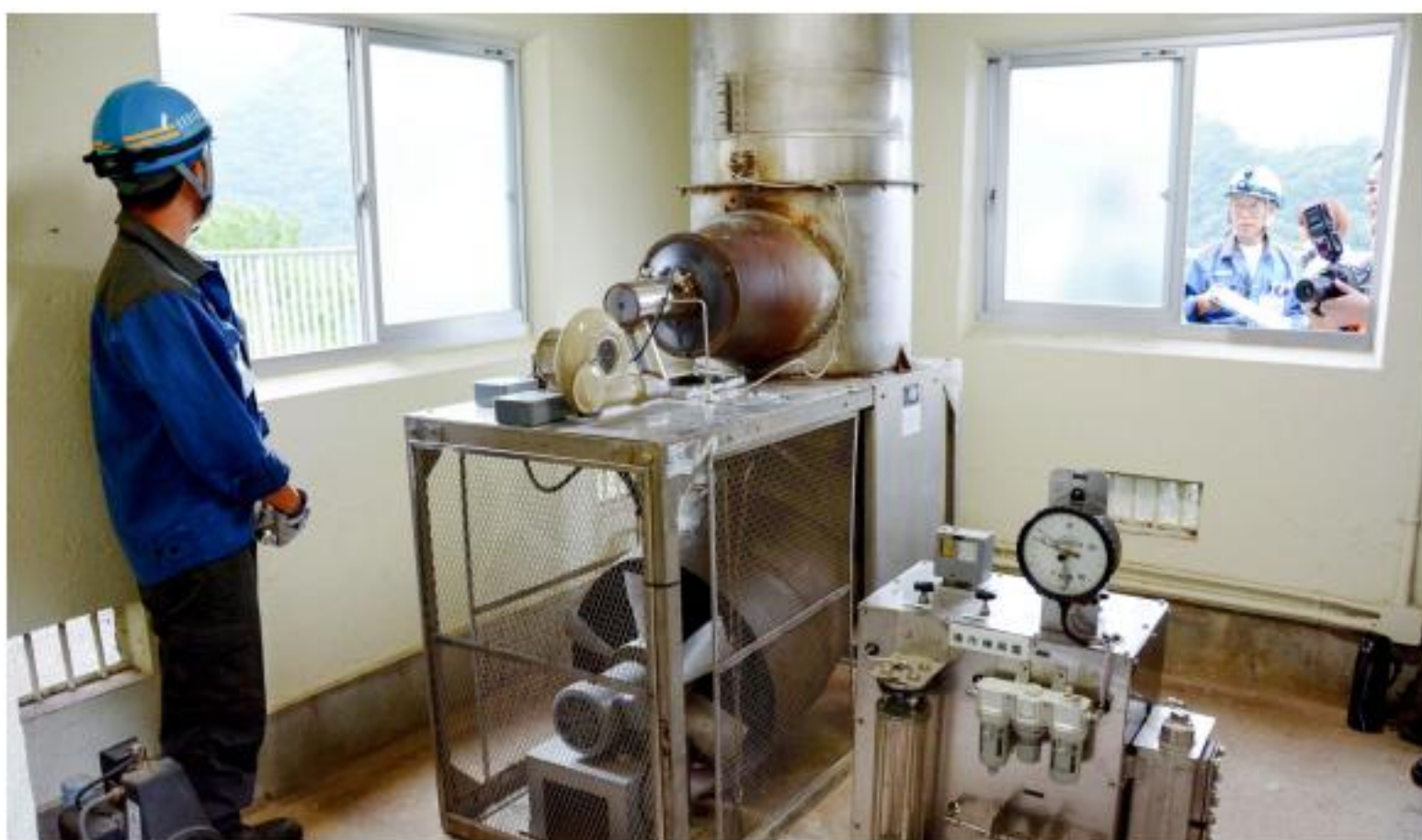
Bên trong một trạm “gieo mây” gây mưa ở Okutama, Nhật Bản.
