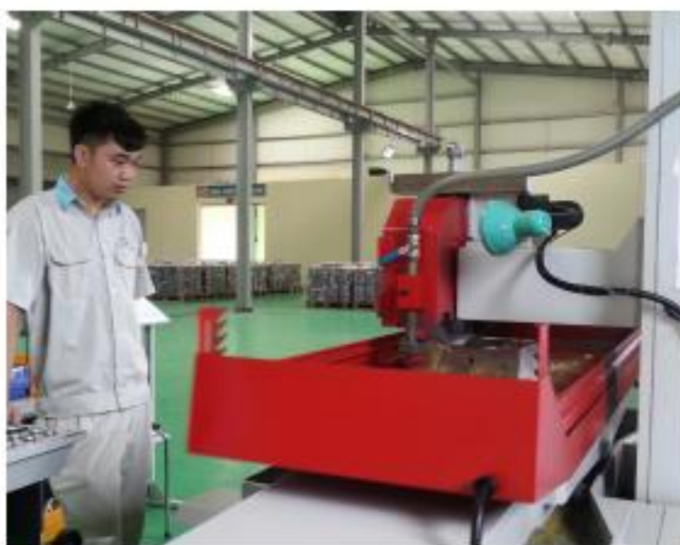
Máy phay sản xuất vỏ điện thoại của Tập đoàn Viễn thông quân đội Viettel. Ảnh: HM
