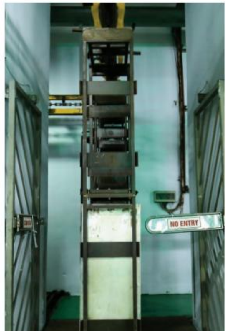
Bên ngoài phòng chiếu xạ - nơi không ai được lại gần. Phía trong, các lò vài được bố trí khoảng cách đồng đều với nguồn xạ nhằm đảm bảo sự đồng đều về liều chiếu.
