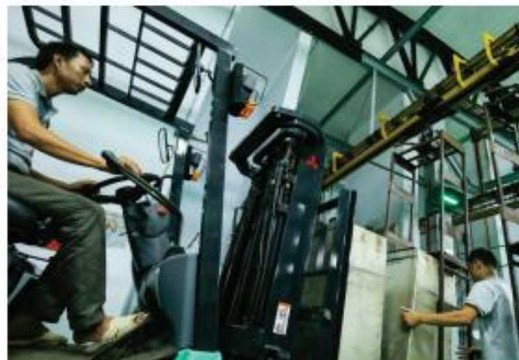
Các lò vài thiếu được đưa từ bằng chuyển xuống để chuyển vào phòng chiếu xạ. Phòng này có thể xử lý 38 lò (tương đương 1,2 tấn vài thiếu) mỗi lần chiếu.
