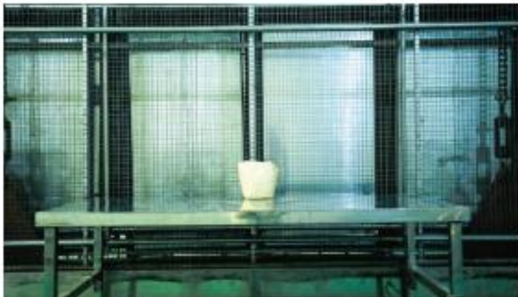
Những hạt đậu tương đạt tiêu chuẩn đang được chiếu tia gamma nguồn Co60 với các liều lượng chiếu xạ 150, 200 và 250Gy.
