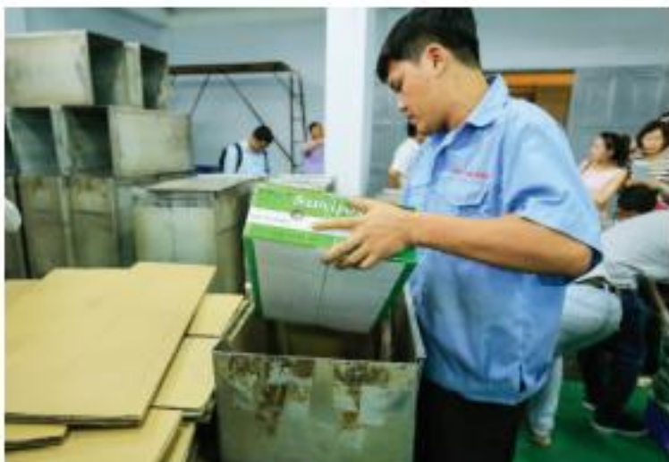
Các thùng vài thiếu được cho vào lò để đưa lên bằng chuyển chuyển sang khu chiếu xạ, nơi vài được chiếu tia bức xạ trong 1,5 giờ nhằm ức chế sự phát triển của vi sinh vật.
