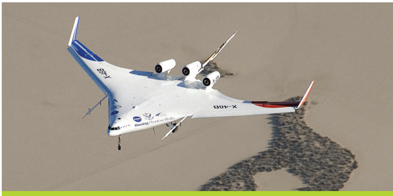
Phòng thí nghiệm nghiên cứu của Không quân Hoa Kỳ, NASA và Boeing đã phát triển X-48B, nguyên mẫu máy bay cánh liên thân siêu hiệu quả. NASA
