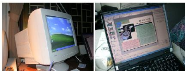
Hình 1.11: Màn hình dùng đèn tia âm cực dùng cho máy tính để bàn (desktop) (bên trái) và màn hình tinh thể lỏng dùng với máy tính xách tay (laptop) (bên phải.)
