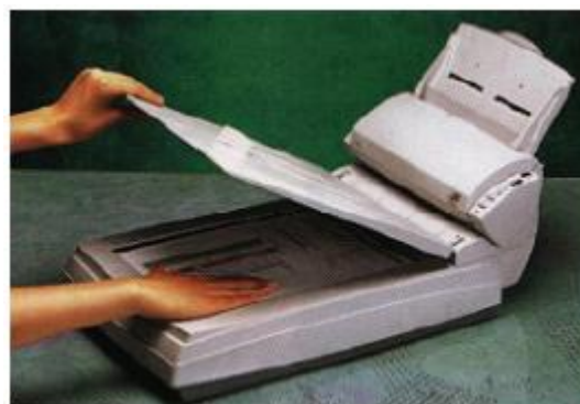
Hình 1.10: Một máy scanner dùng với giấy khổ A4 có tốc độ đọc 900
