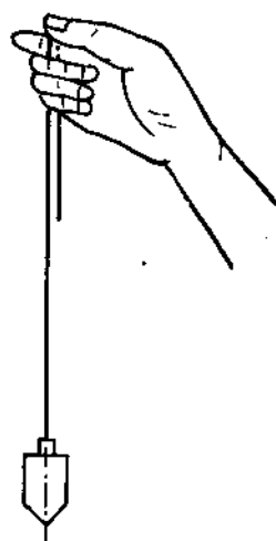
Hình 9 : Cách cầm dây dọi
