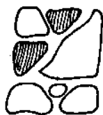
Hình 3- 116 : Viên đá có đầu nhọn cắm xuống dưới
