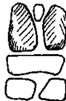
Hình 3- 120 : Xây đá theo kiểu dựng bia
