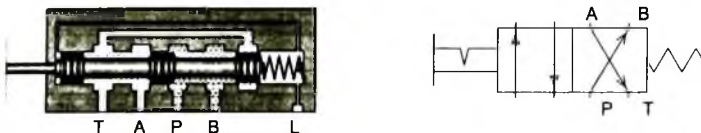
Hình 5.37: Cấu tạo, kí hiệu van 4/2
