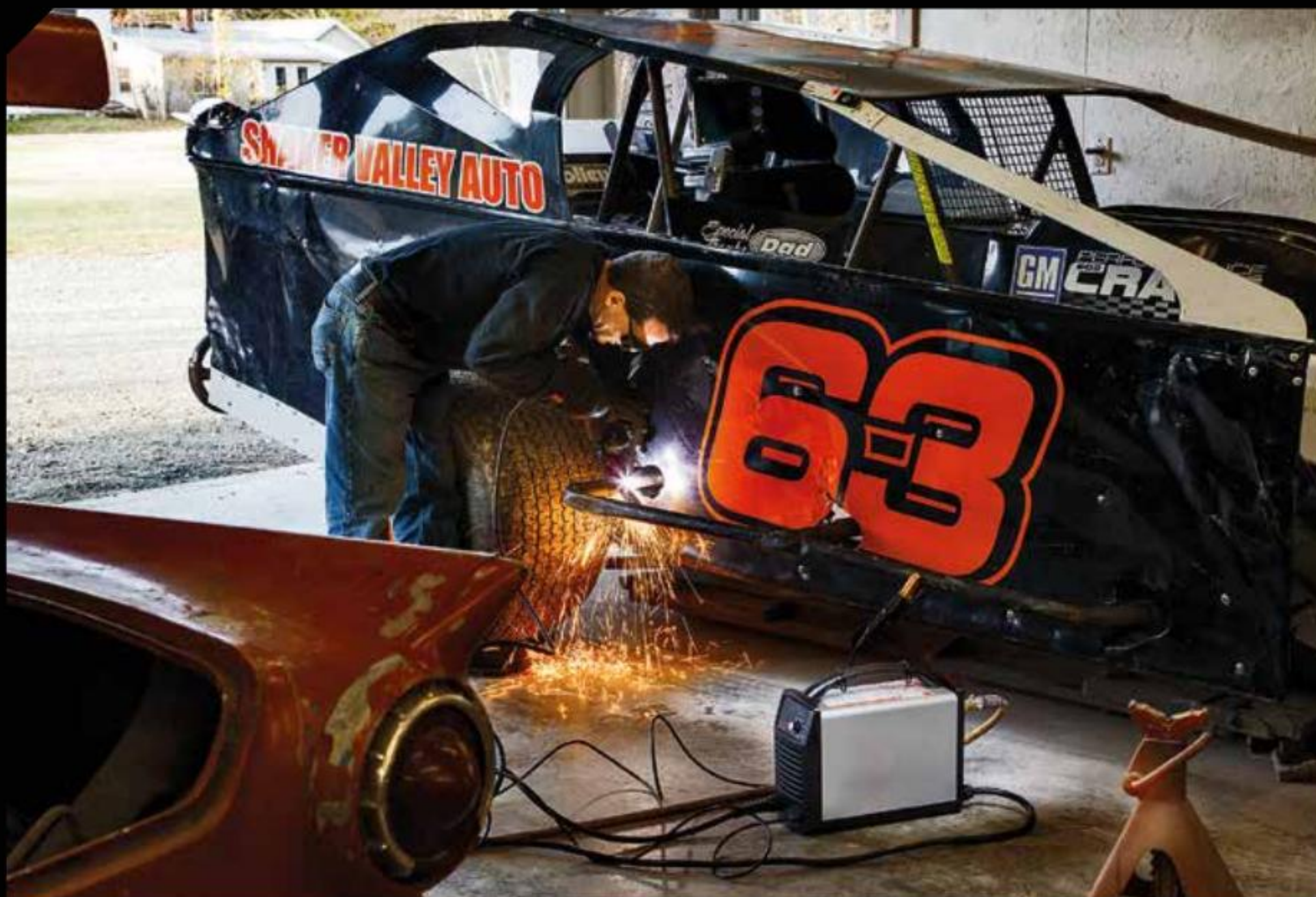
Cắt plasma là quá trình cắt bằng nhiệt, trong đó chùm khí ion hóa cấp nhiệt cho kim loại dẫn nhiệt đến nhiệt độ cao hơn nhiệt độ nóng chảy của kim loại và thổi phần kim loại nóng chảy qua rãnh cắt.
