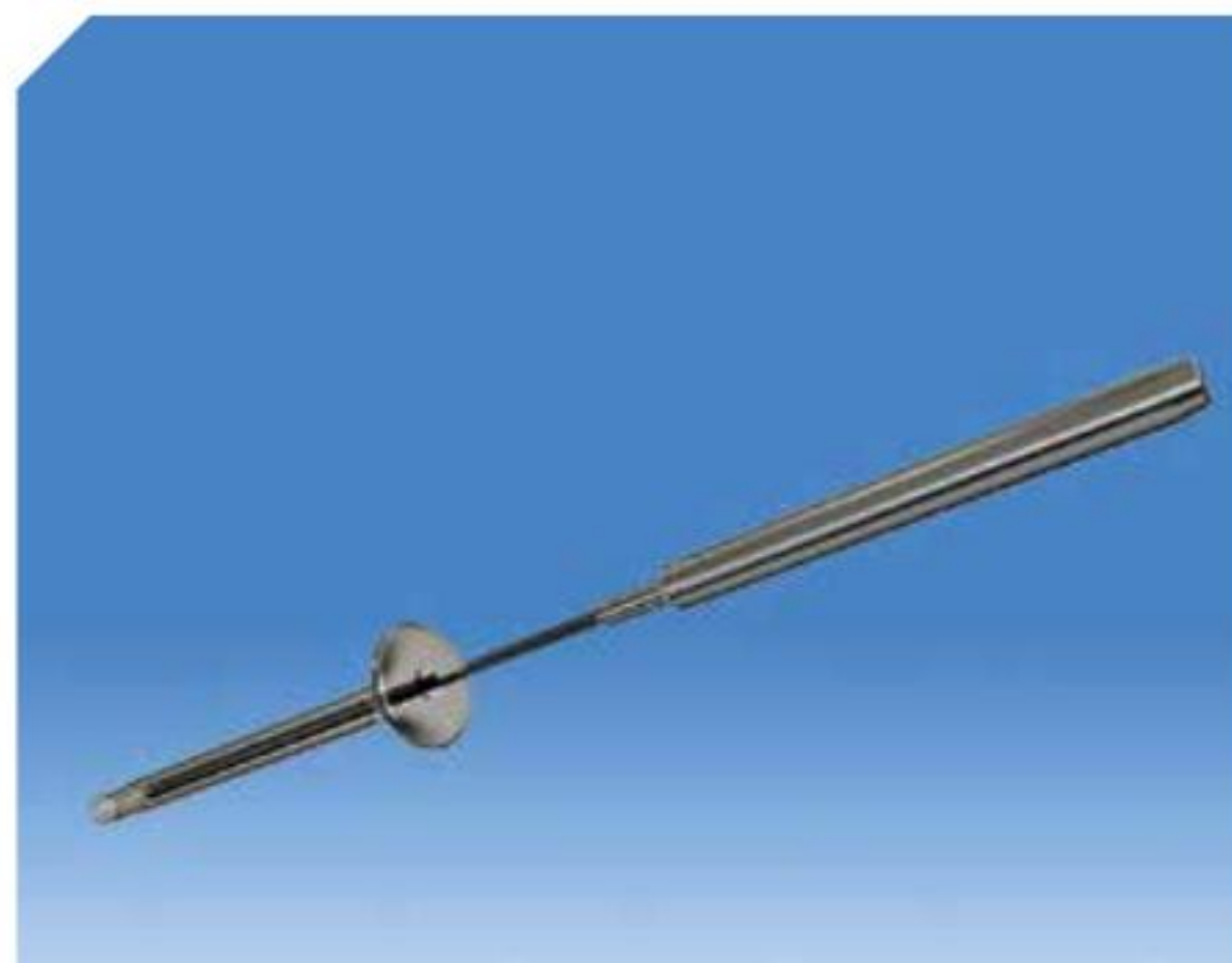
Hình 3: Mũi khoan Gundrill bảo đảm độ bóng bề mặt như yêu cầu, chủ yếu dùng cho các ứng dụng gia công lỗ van. Ứng dụng khoan lỗ với đường kính lỗ từ Ø0.9mm đến Ø16mm, khoảng dung sai IT7, độ bóng bề mặt Ra 0.4 - 1.6 \mu m
