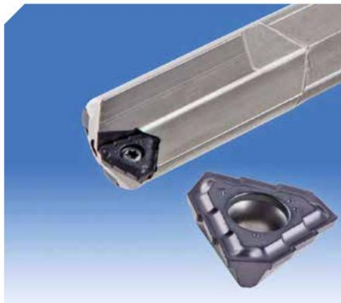
Hình 4: Dòng mũi khoan TRI-DEEP (GD-DH...) có khoảng dung sai IT10 và đường kính khoan lỗ từ Ø 16- Ø28 mm. Mảnh cắt TOGT tiêu chuẩn có ba lưỡi cắt răng cưa tạo ra các mảnh phoi mỏng và ngắn.
