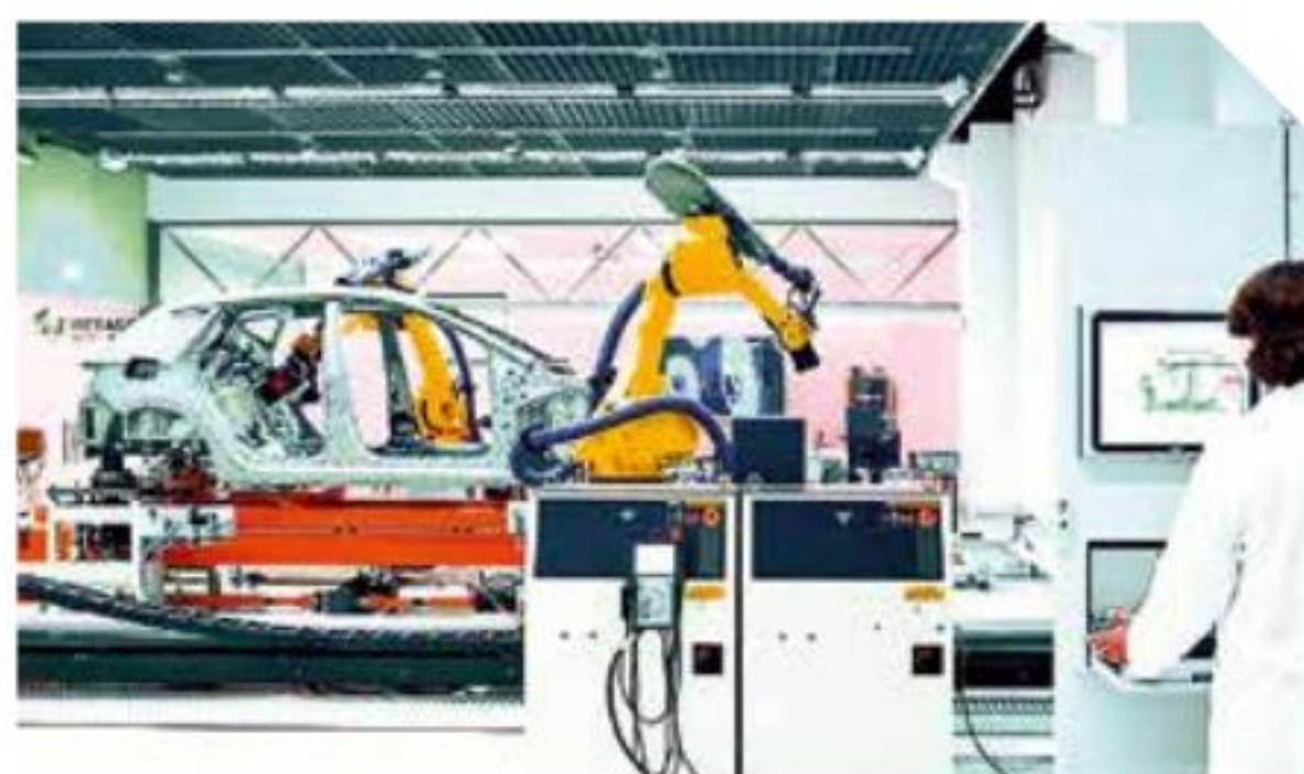
Công nghệ quét ánh sáng trắng còn có thể được sử dụng để đo đạc trực tiếp trong dây chuyền sản xuất.
