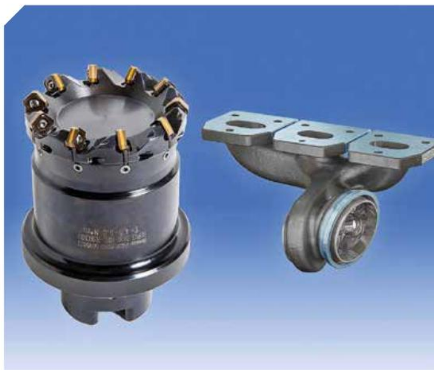
Hình 1: Ví dụ, phay phá mặt Ø100mm của ISCAR SOF45 8/16-D100-10-32R, được trang bị 10 lưỡi dao tiêu chuẩn S845 SNHU 1305 ... MS32 để dàng cắt thép đúc Austenitic chịu nhiệt với chiều sâu cắt a_p = 6\text{mm} , ở vận tốc cắt V_c = 150\text{ mét / phút} và bước tiến bàn dao f = 3\text{mm / vòng} và đạt tuổi thọ dao động từ 25-30 sản phẩm trên mỗi góc cắt. Các sản phẩm của đối thủ cạnh tranh chỉ đạt được 12 sản phẩm trên mỗi góc cắt.
