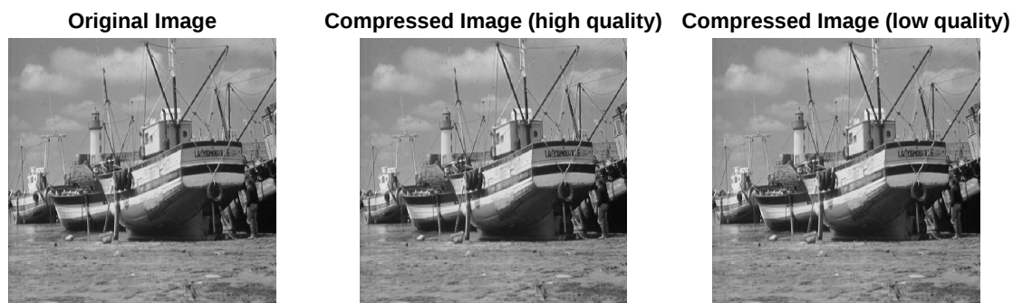
Hình 7.1: Ví dụ về nén ảnh JPEG. Ảnh bên trái: ảnh gốc, không nén. Ảnh ở giữa, nén với tỉ lệ thấp (cho ra ảnh chất lượng cao hơn) và ảnh bên phải: nén tỉ lệ cao.
