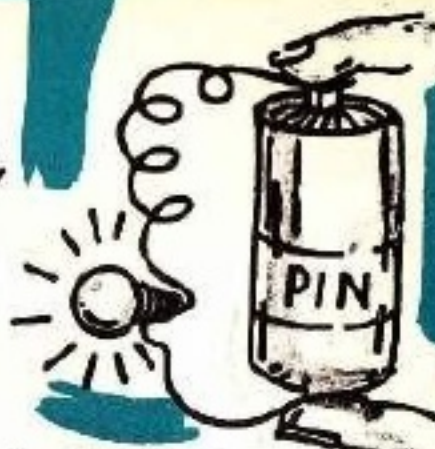
(dây đồng nối 2 cực của pin) Pin với sợi dây đồng có gắn bóng đèn
